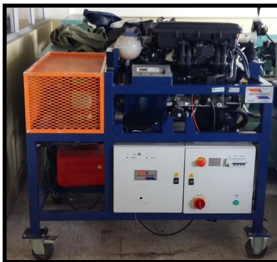
Fig. 2 : Banco dinamométrico acoplado al eje.
