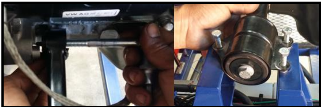
Fig 42: Desmontaje de barra estabilizadora
