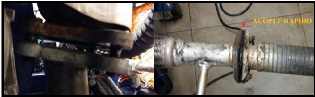
Fig 35: Juntas de acople del tubo de escape Fuente: Autores
