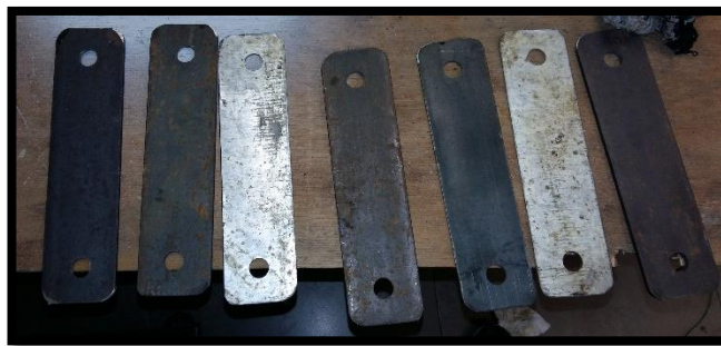
Fig 76: Alzas de regulación de la base de la barra estabilizadora
