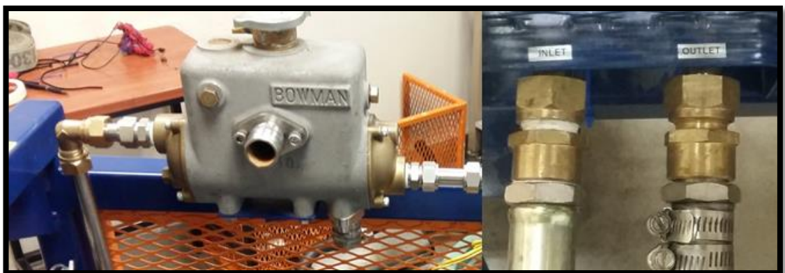
Fig. 15: Intercambiador de calor Fuente: Autores
