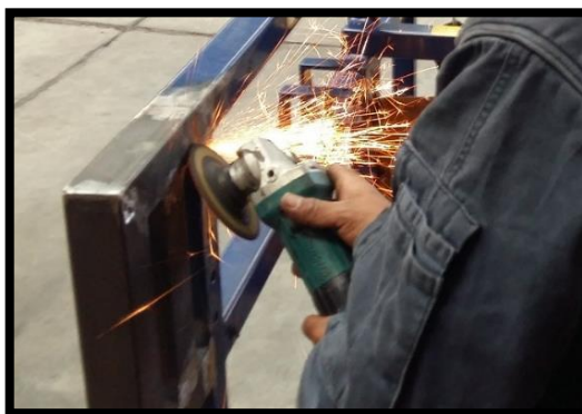
Fig 53: Retiro de escoria de suelda mediante una amoladora.
