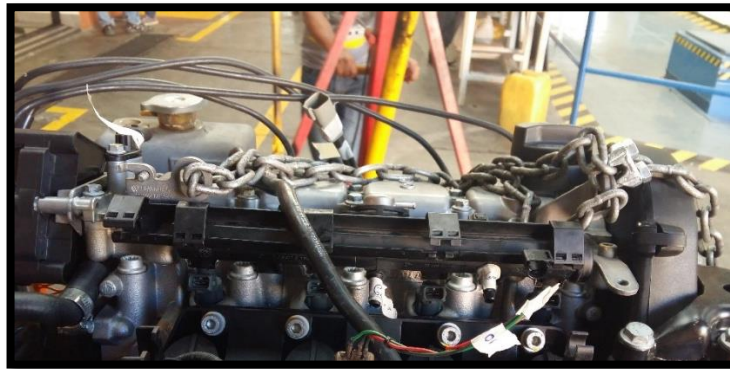
Fig 41: Colocación de cadena metálica con el tecla
