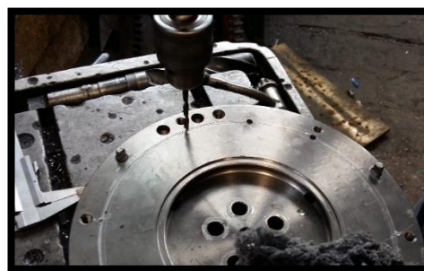
Fig 50: Agujeros realizados con el taladro
