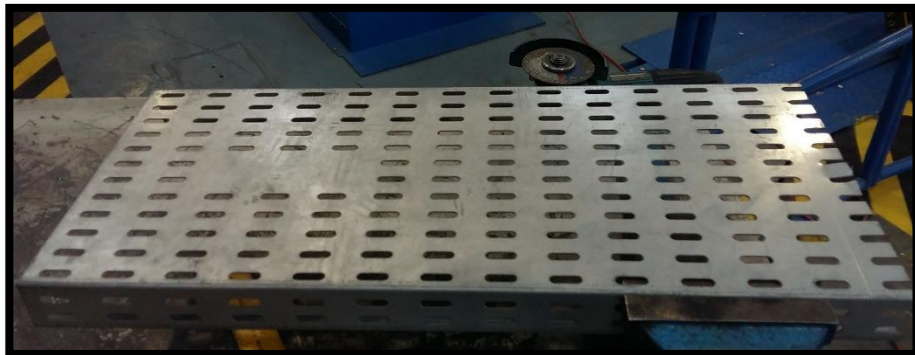
Fig 83: Plancha metálica con ranuras continuas Fuente: Autores
