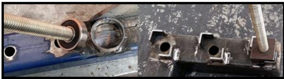
Fig 61: Tornillo acoplado al rodamiento y al cuadrado metálico
