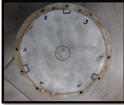
Fig 46: Acople del freno electromagnético con el volante motor modificado
