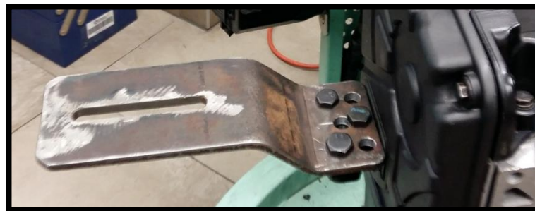
Fig 66: Acople 3 montado en el motor a prueba Fuente: Autores
