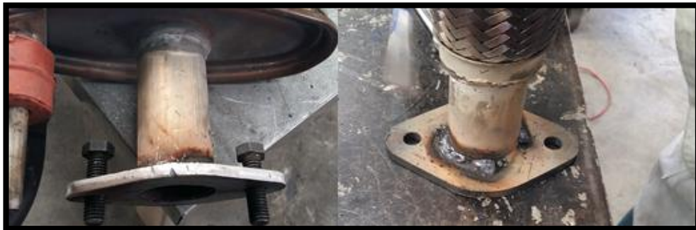
Fig 78: Acoples soldados a entrada y salida del sistema de escape
