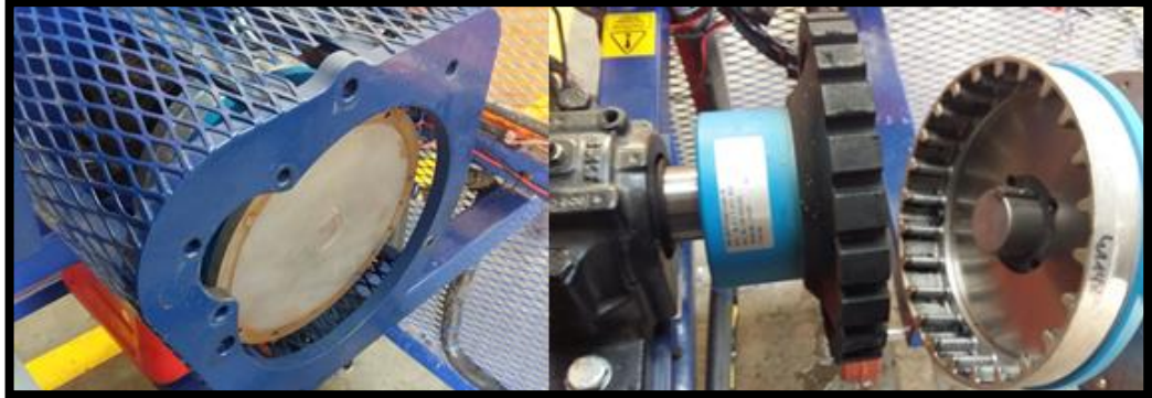
Fig 45: Desacople del freno electromagnético con el motor
