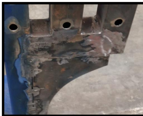
Fig 79: Lijado de las escorias por la suelda
