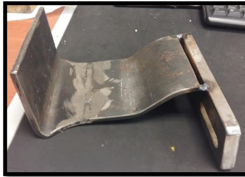
Fig 69: Unión de planchas del acople 4
