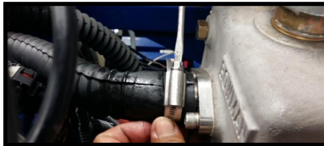
Fig 36: Mangueras de refrigeración del motor Fuente: Autores
