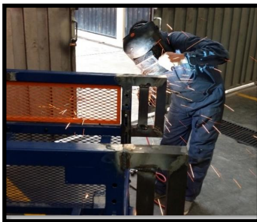
Fig 52: Alargamiento de la estructura robusta
