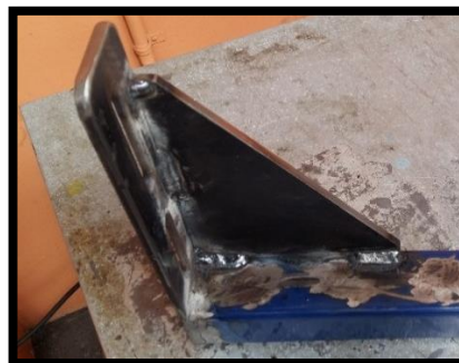
Fig 57: Platinas y apoyos soldados para formar Acople 1
