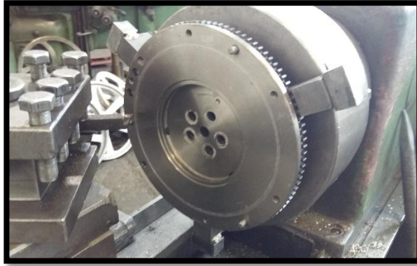
Fig 48: Volante motor montado al torno para señalar el diámetro
