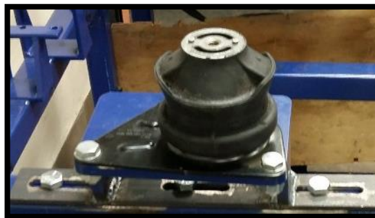
Fig 64: Acople 2 unido a base de caucho 1
