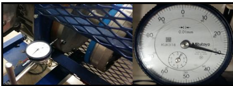
Fig 34: Medición con el Reloj Comparador Fuente: Autores
