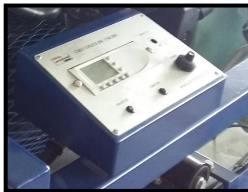
Fig 32: Controlador lógico, potenciómetro de aceleración y frenado en su posición original
