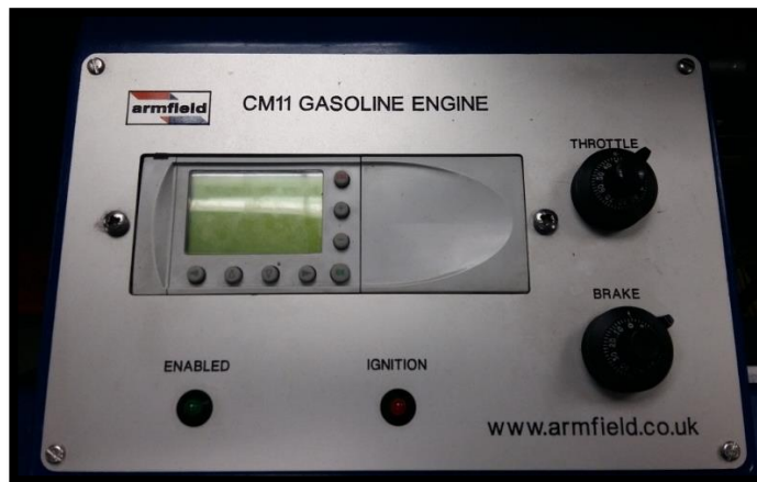
Fig 22: Controlador lógico, Potenciómetro de aceleración y de freno Fuente: Autores
