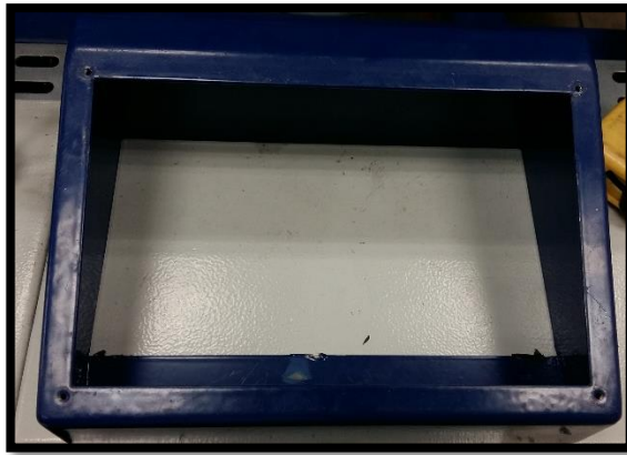
Fig 84: Agujeros para acoplar el conjunto del controlador lógico Fuete: Autores
