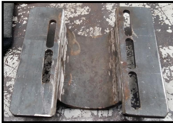
Fig 74: Platinas reguladoras hacia adentro y hacia afuera de la base metálica de la barra estabilizadora
