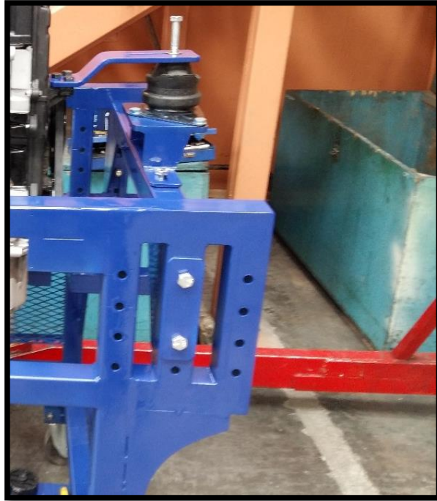
Fig 88: Acople del motor con la estructura de soporte 1 Fuente: Autores
