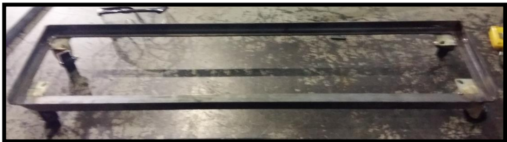
Fig 85: Base para el gabinete electrónico y eléctrico Fuente: Autores
