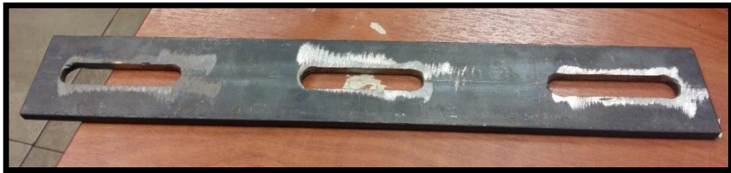
Fig 63: Platina metálica de regulación del acople 2
