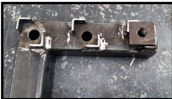
Fig 59: Base de acople 1 con moldes y cuadro metálico roscado en el centro Fuente: Autores
