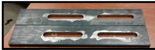
Fig 56: Platinas sin soldar del Acople 1
