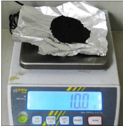
*Figura 16 Gramos de suelo tamizado y homogéneo*
