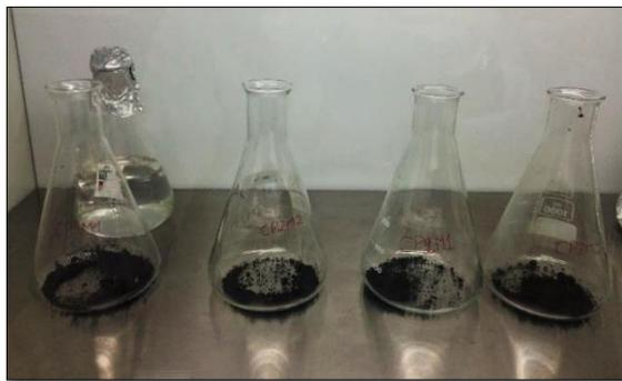
*Figura 17 Suelo tamizado en matraces de 1000ml para cultivo líquido*
