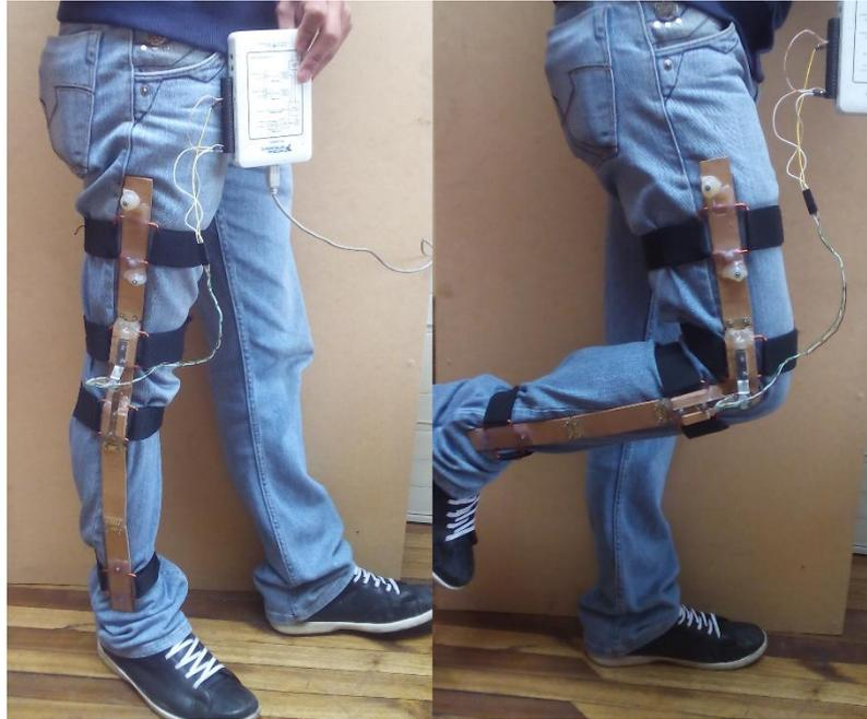
**Figura 22:** Dispositivo de adquisición de trayectoria de ángulo de caminata colocado en una persona.
