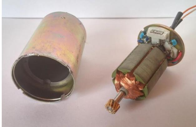
**Figura 59:** Motor DC Copal desarmado.
