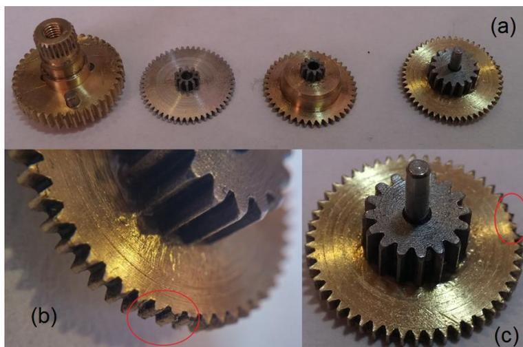
**Figura 65:** (a) Engranés de cobre del Motor MG995. (b,c) Engrane con dientes dañados.
