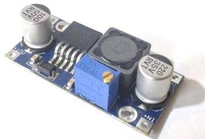
**Figura 13:** Módulo convertidor boost XL6009.
