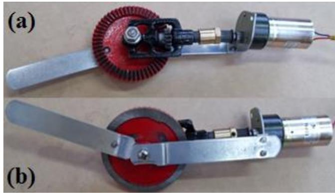
**Figura 36:** *Acoplamiento del generador del motor DC copal LC 30G en el soporte metálico de la rodillera: a) Vista superior, b) Vista posterior.*
