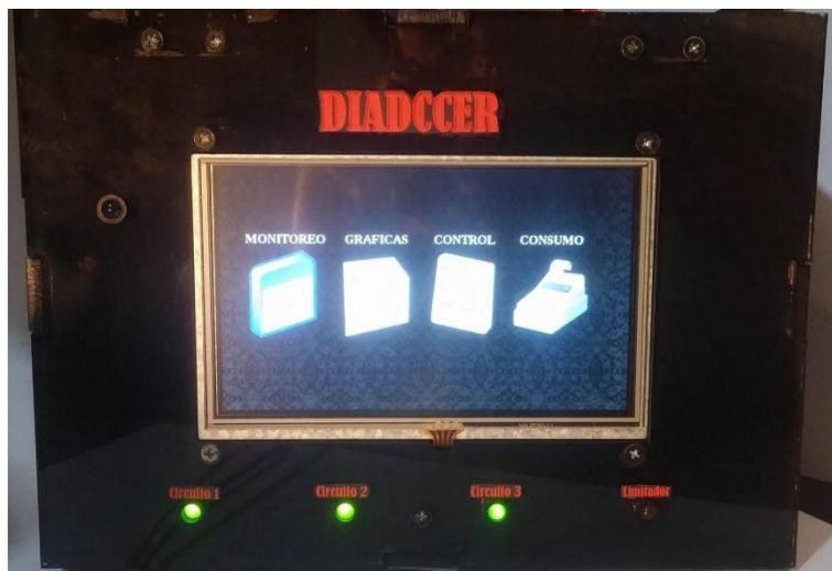
*Ilustración 51. Parte frontal del chasis.*
