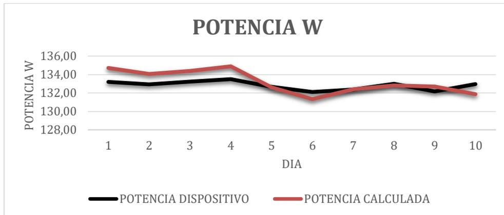
Ilustración 57. Variación de la potencia Luminarias.
