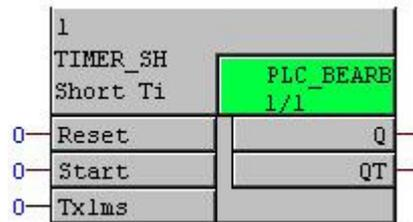
Figura 40. Bloque CFC TIMER\_SHORT en DIGSI.
