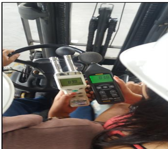
Ilustración 33. Medición del Ruido en el Monta carga.
