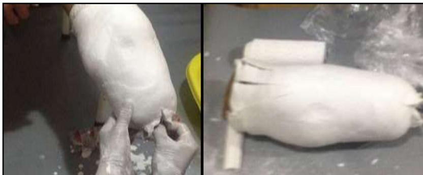
Figura 93. Extracción del molde de yeso
