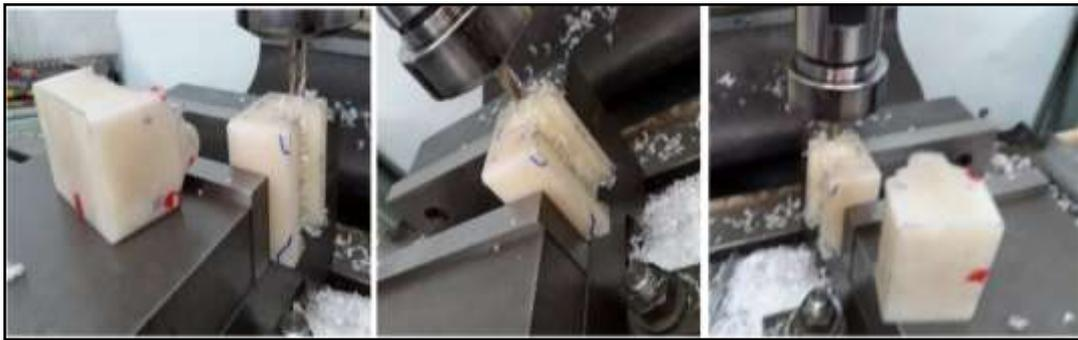
*Figura 85. Mecanizado de la base y la tapa.*
