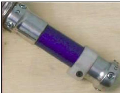
Figura 96. Elementos de ajuste para el socket
