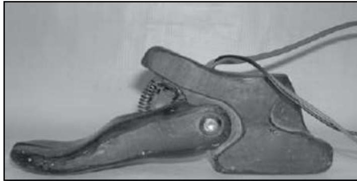
Figura 42 Prototipo de la prótesis mecánica con alambre de nitinol [31].
