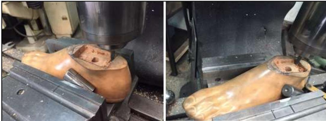
*Figura 88. Mecanizado del pie de Sach básico.*
