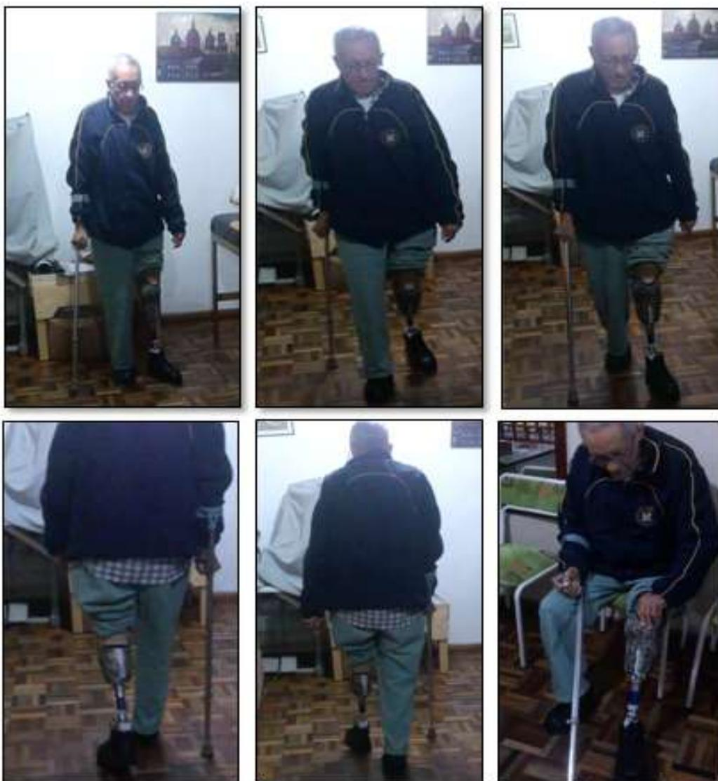
*Figura 103. Pruebas de marcha con la prótesis de tobillo mecánica con tres grados de libertad en el paciente. Los ajustes sobre la descarga de la carga puesto que es importante que al descargar el peso cuando se genera el paso se debe colocar primero el talón y no todo el pie, se realiza un ajuste en la restricción de flexo-*
