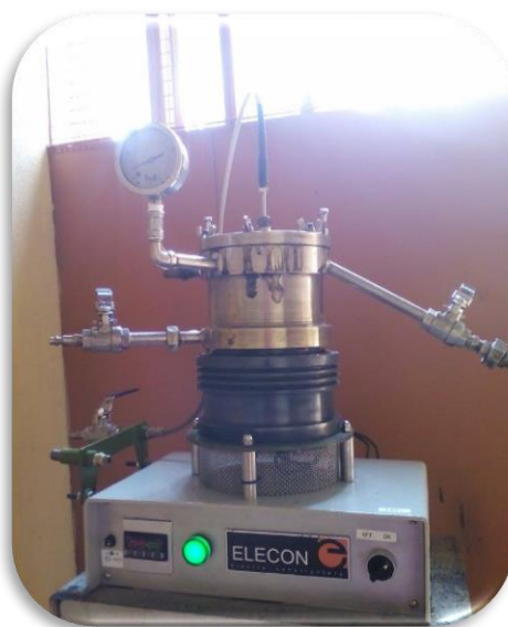
Figura 11: Equipo de pirolisis Fuente: La autora – Diciembre 2015
