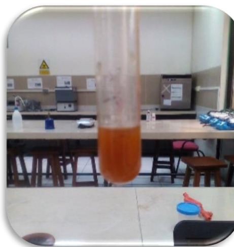
Figura 25: Resultado de la reacción con permanganato de potasio Fuente: La autora – Mayo 2016
