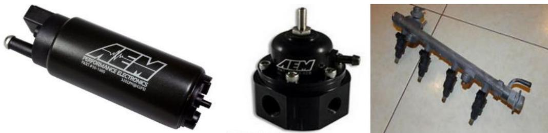
Figura 4.4 Elementos del sistema de inyección
