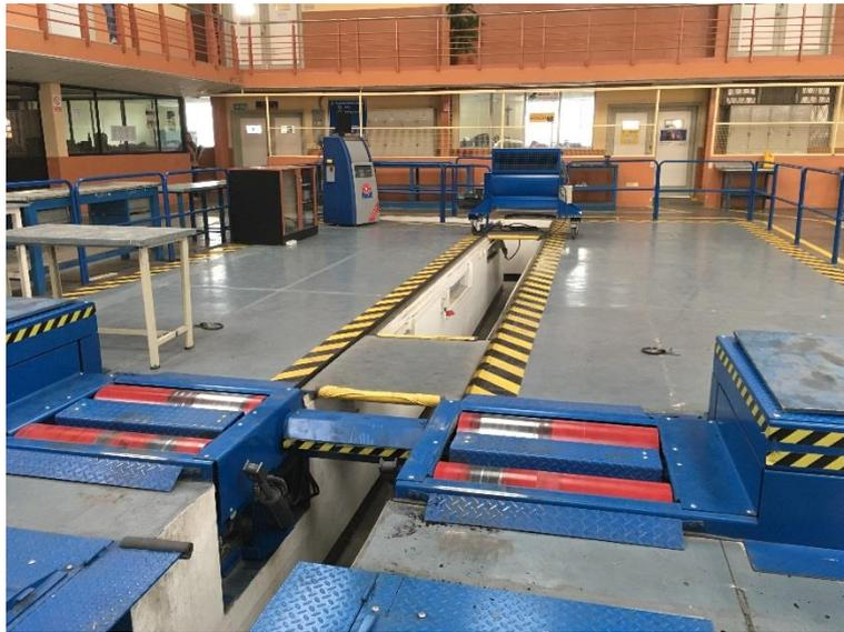
Figura 4.10 Banco dinamométrico
