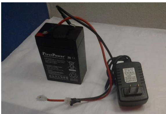
Figura 3.3 Elementos de Alimentación Batería y Adaptador AC/DC.
