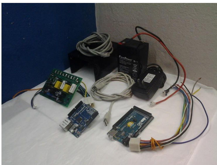
Figura 3.1 Equipo para el monitoreo del sistema de alimentación de la cámara del ECU 911 Austro.
