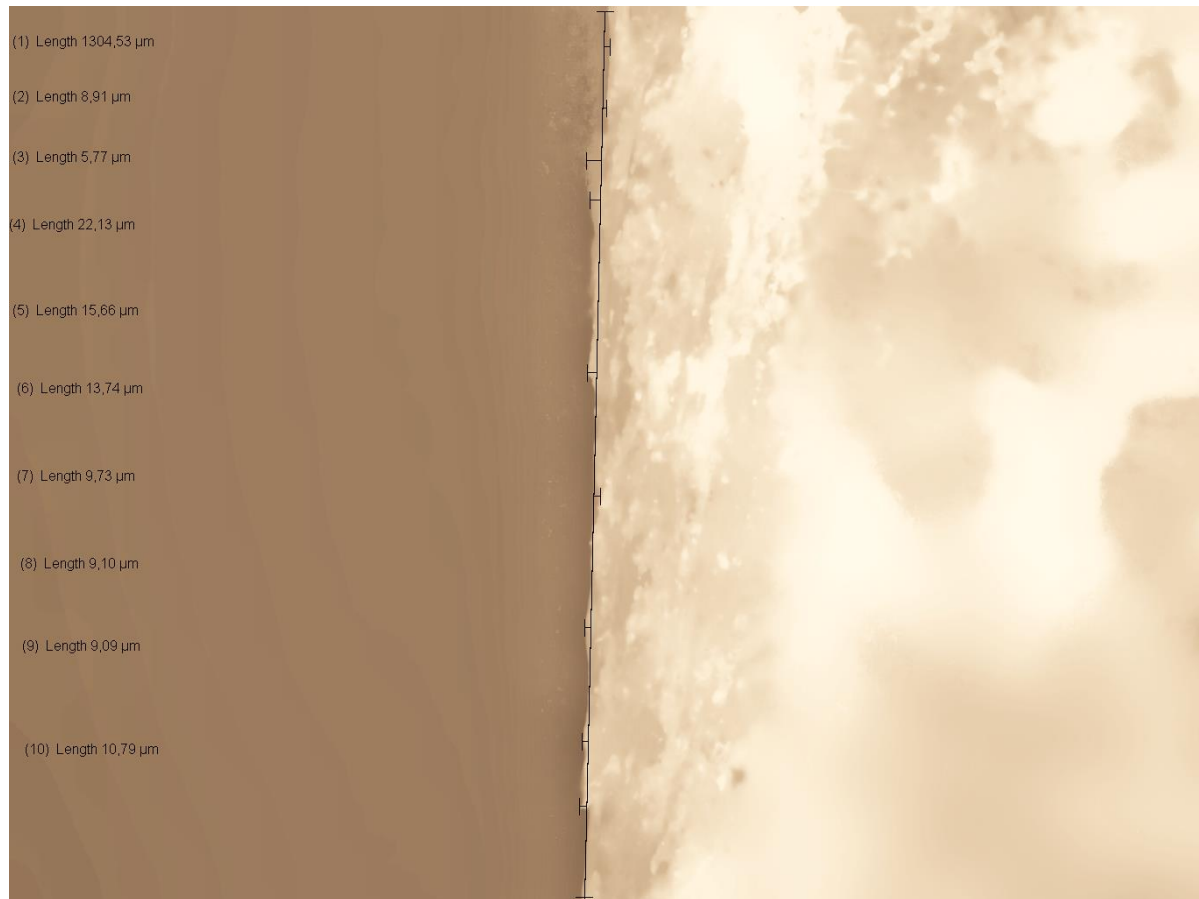
Figura 3.13: Imagen 10 X / 0.30 BD de Polipropileno - Pino
