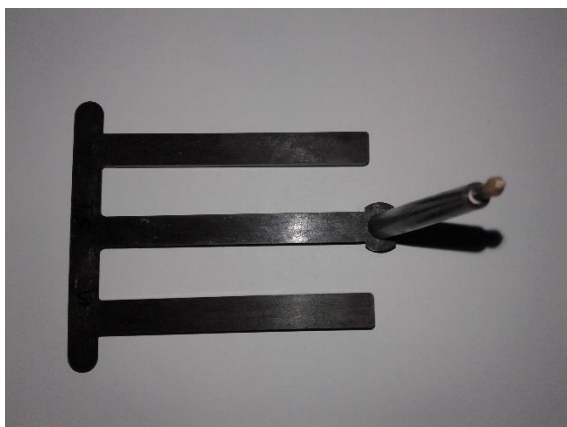
Figura 4.6 a: Probeta de PP-Eucalipto- 5% lubricante
