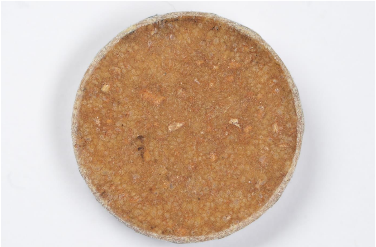
Figura 3.12: Probeta compactada de Polipropileno - Pino
