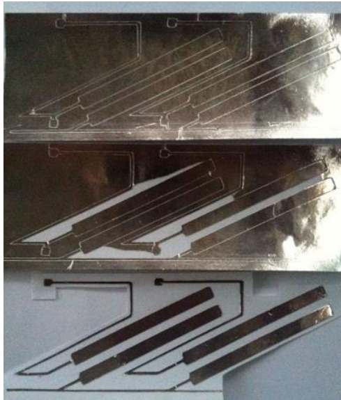
Figura 11: Desarrollo de cada sensor, cortado a través de un plotter.
