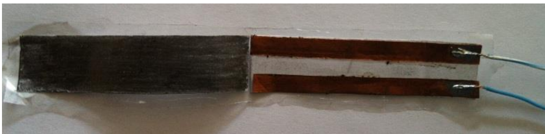
Figura 14: Estructura interna del sensor de presión capacitivo.
