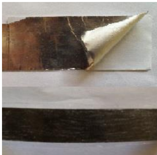
Figura 7: Lámina adhesiva de aluminio en la parte superior y carbón en la parte inferior.
