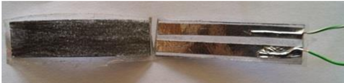
Figura 8: Estructura interna del sensor de presión capacitivo (aluminio).
