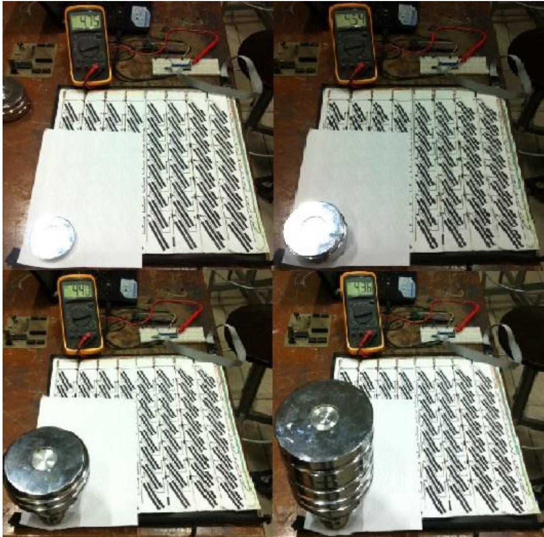
Figura 21: Pruebas de funcionamiento de la matriz construida 8x8.
