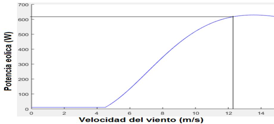
Figura 35. Curva de potencia de salida con respecto a la velocidad del viento.
