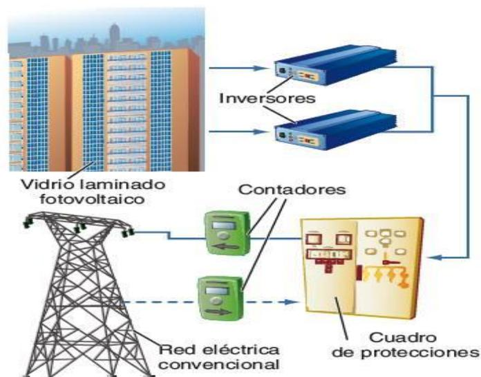
Figura 4. Sistema distribuido que intercambia energía con la red eléctrica. (Chuqui M. 2014)
