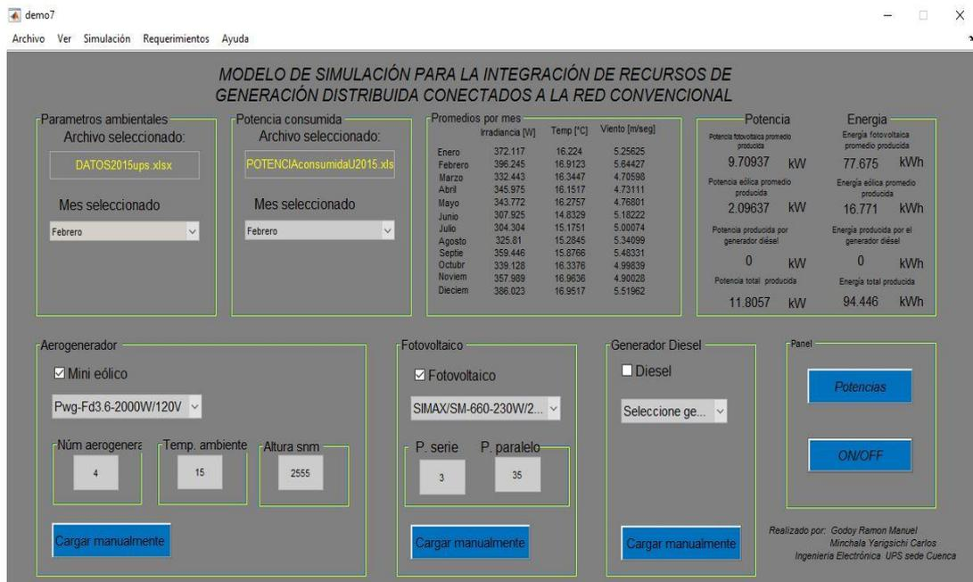
Figura 47. Interfaz gráfica implementada en Matlab para controlar el modelo de simulación implementado en Simulink.
