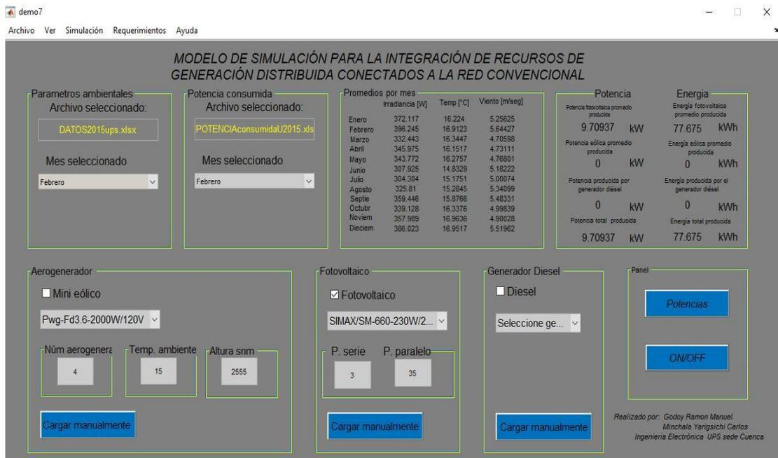
Figura 53. Interfaz gráfica implementada en Matlab para controlar el modelo de simulación implementado en Simulink.
