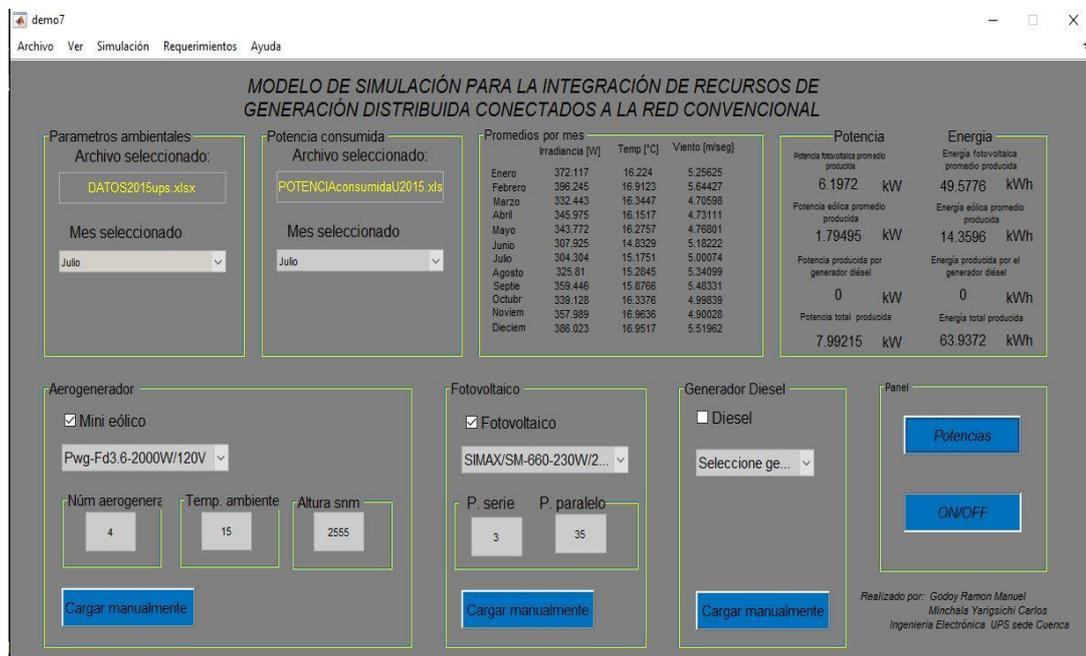
Figura 69 Interfaz gráfica implementada en Matlab para controlar el modelo de simulación implementado en Simulink.
