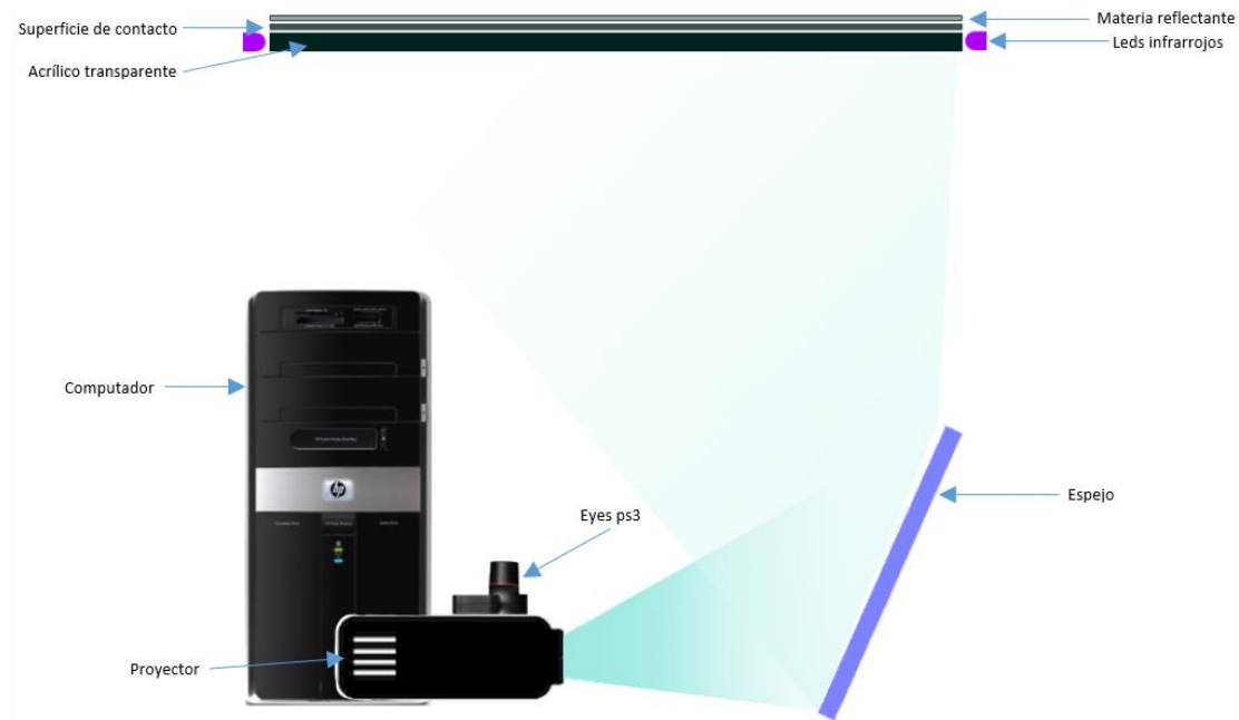
Figura 3. Estructura lógica para la construcción de la mesa táctil
