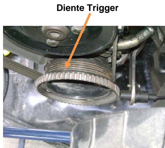
FIGURA 3.17 POSICIÓN DEL DIENTE TRIGGER. Fuente: Los Autores
