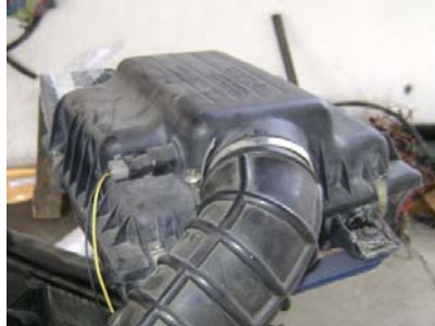
FIGURA 3.24 POSICIÓN DEL SENSOR TEMPERATURA DE AIRE
