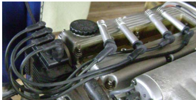
FIGURA 3.9 CABLES DE ENCENDIDO.
