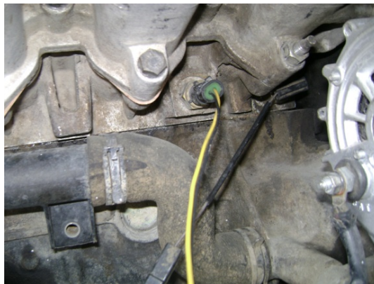
FIGURA 3.26 POSICIÓN DEL SENSOR DE TEMPERATURA DE AGUA Fuente: Los Autores
