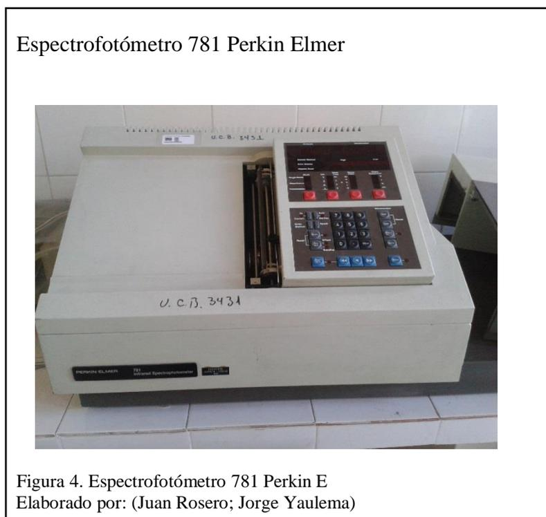
Se va a encontrar un espectrofotómetro de la compañía estadounidense Perkin Elmer del modelo 781 como se ve en la Figura 4, el cual sirve para análisis de muestreo químico de diferentes fluidos, en función a las diferentes longitudes de onda generadas por una fuente luminosa, así se puede medir niveles de concentración química y reacciones en la misma.
