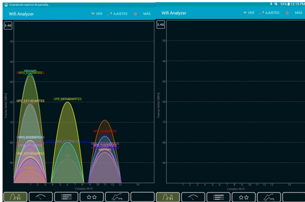
Figura 33. Capturas de las redes en Cisco encendido el jammer y apagado Fuente: Wifi Analyzer
