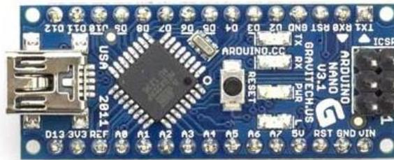
*Figura 2. 3. Módulo de Arduino Nano [19].*
