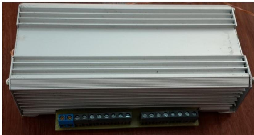
**Figura 3. 6.** Carcasa de aluminio implementada.
