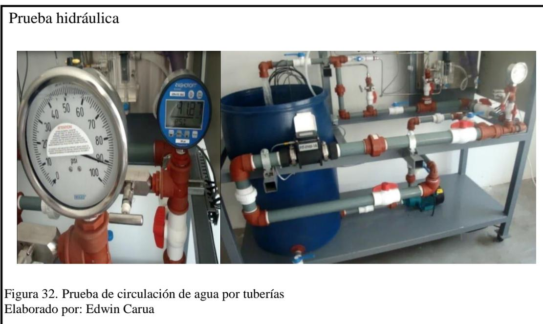
De acuerdo con esta prueba se pudo observar que con la mayor presión que suministra la bomba no se detectaron fugas de agua en todo el banco, lo que garantiza que la tubería y demás accesorios resisten a la presión respecto a sus especificaciones técnicas, y se comprueba que se encuentran correctamente acopladas.
