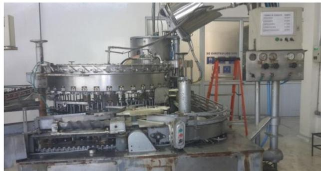
Figura 17. Llenadora y encapsuladora de la línea Crown-Pet.
