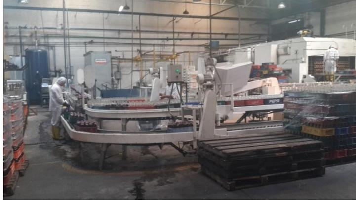
Figura 13. En la imagen se aprecia una parte de la línea Crown-Vidrio, donde al lado derecho se aprecia la lavadora así como otros elementos como las cadenas de distribución.
