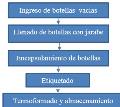
Figura 18. Proceso que se realiza en la Línea Crown Vidrio para realizar la producción de sus envases Pet. Elaborado por: Andrés Calero, Karla Correa.
