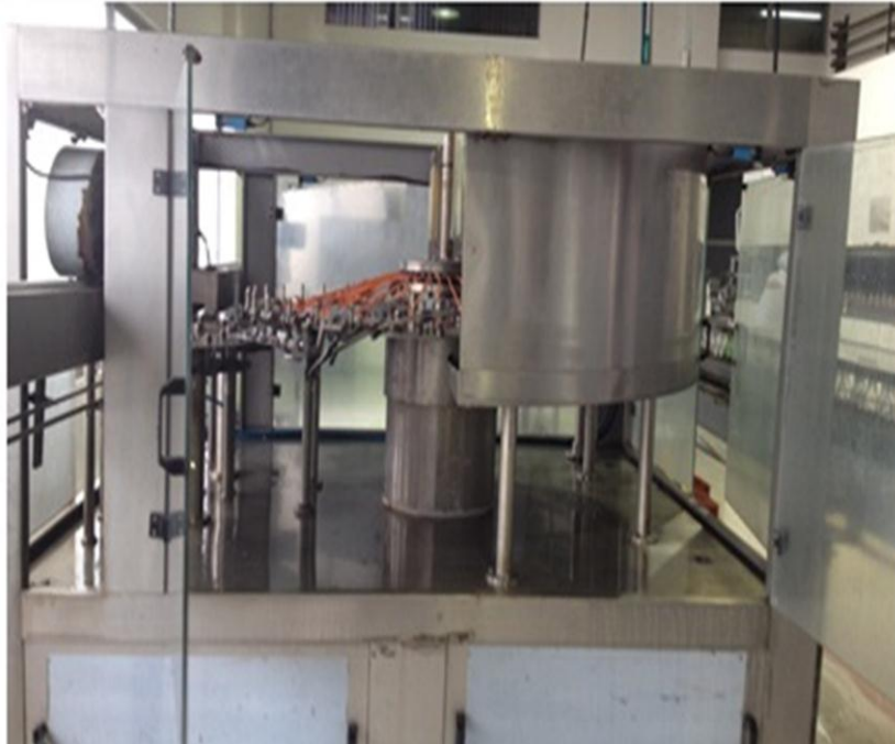
Figura 4. Vista Lateral de la máquina Rinseadora, salida de las botellas al túnel de viento accionado por el blower. Elaborado por: Paul Cadena S.
