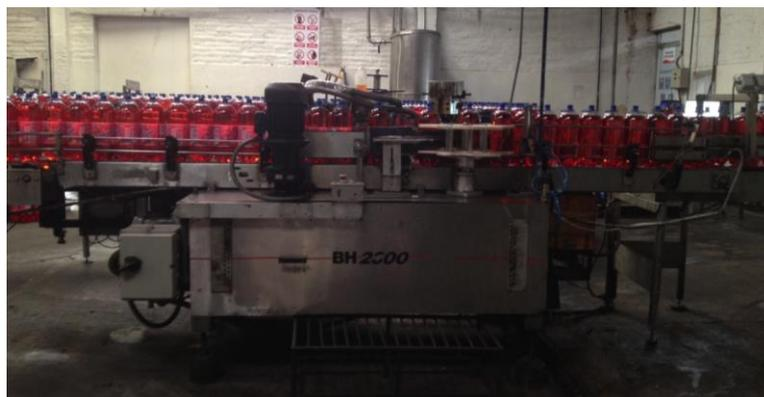
Figura 9. Etiquetadora vista frontal
