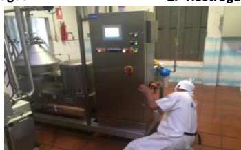
3.-Lavado con agua caliente
