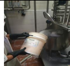
2.- Lavado con sosa por 30 min a 90°C
