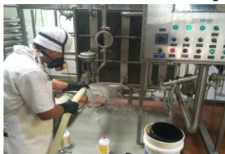
3.- Lavado con agua caliente
