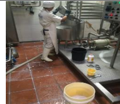
2.- Lavado con sosa por 30 min a 90°C
