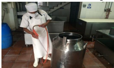
3.-Desinfecte con agua caliente 90°C
