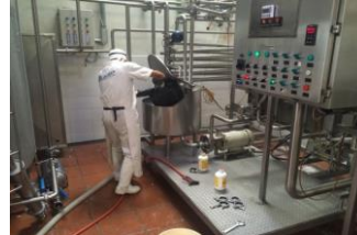
4.- Lavado con Ácido Nítrico por 15 min a 90°C
