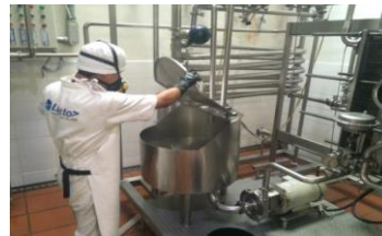
4.- Lavado con Ácido Nítrico por 15 min a 90°C
