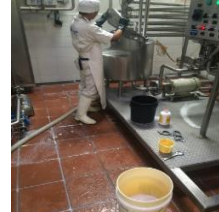
2.- Lavado con sosa por 30 min a 90°C
