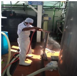
3.-Desinfecte con agua caliente a 90° por 3 minutos
