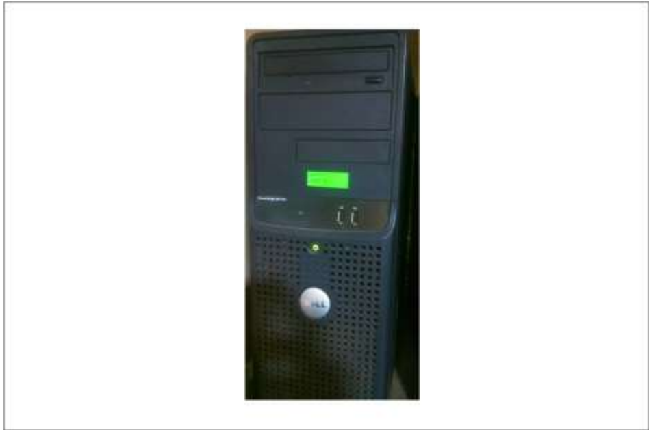
Imagen 10: Servidor proxy – firewall Dell Power Edge SC430. Fuente: El Autor
