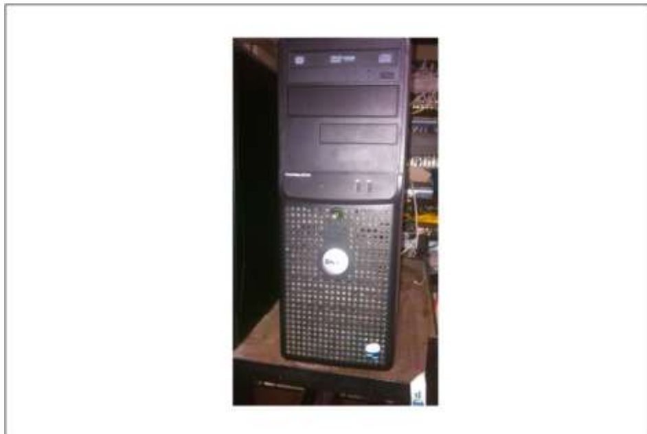
Imagen 13: Servidor de telefonía IP Tuval.
