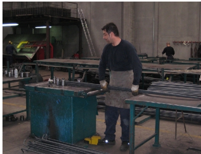
Figura 2.2. Figurado de barras de acero mediante dobladora semiautomática
