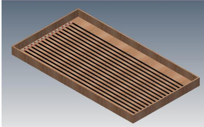
**Figura 40:** Contenedor de la red de tuberías del Colector Solar
