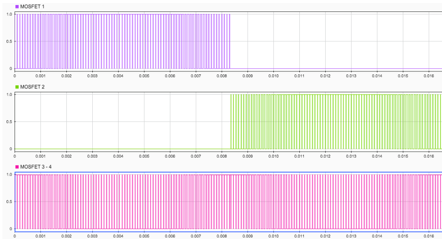
Figura 4.10 Modulación PWM ocupada por la Topología Conergy NPC.
