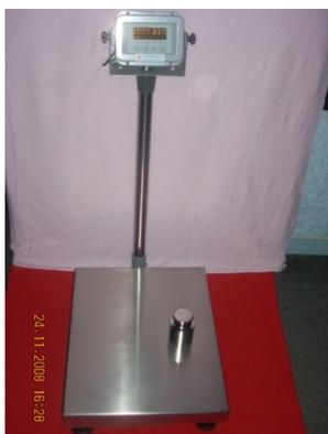
La balanza electrónica es necesaria para pesar la materia prima al momento de ingresarla en la bodega y también cuando sale de la bodega para iniciar el proceso de elaboración del café de haba. Tiene una capacidad máxima de 50 Kg y un tamaño de 300 mm de largo x 400 mm de ancho x 95mm de alto, tiene un peso de 10kg, utiliza energía de 110V.
