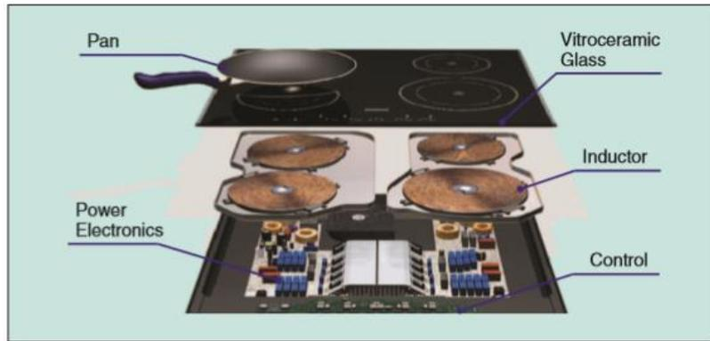
Ilustración 2 Estructura de una cocina por inducción [15].
