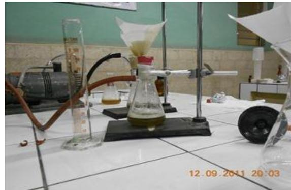
Ilustración: Filtrado del sustrato durante los días de pruebas
