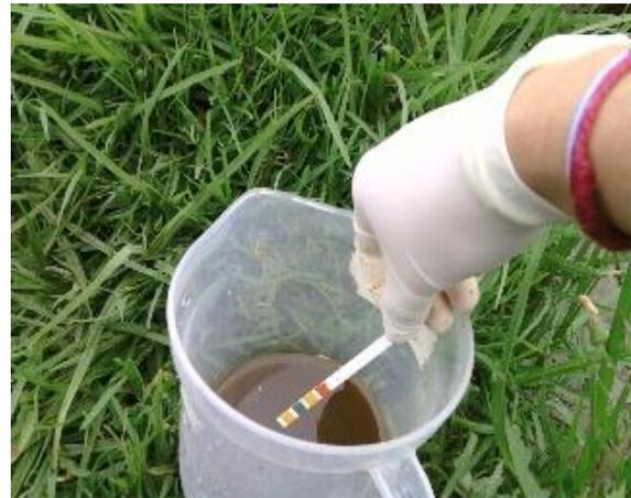
Ilustración: Medidas de datos físicos del agua del biodigestor, T°C y pH.
