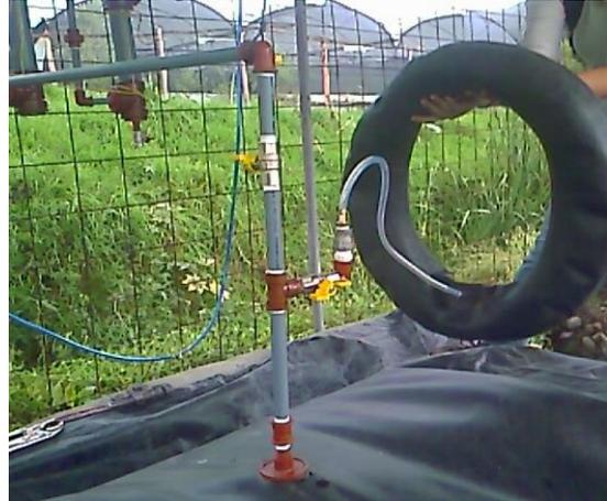
Ilustración: Biogás disponible y almacenamiento de metano en el neumático
