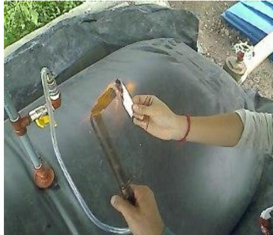
Ilustración: Comprobación del biogás y quema de biogás generado.
