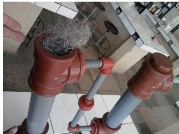
Ilustración: Preparación del filtro con los respectivos purificantes e instalación
