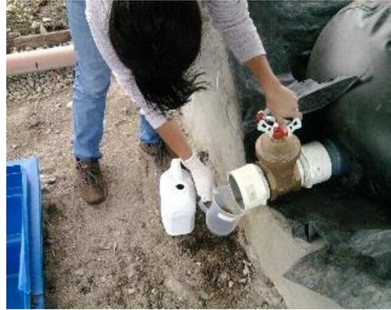
Ilustración: Recolección de la muestra del sustrato de la salida del biodigestor.
