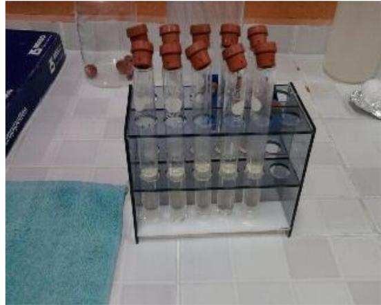
Ilustración: Preparación de agua peptonada para el análisis de coliformes totales.
