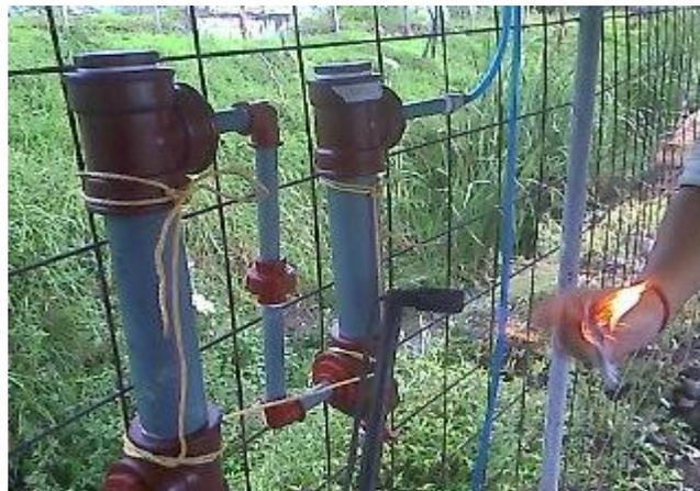
Ilustración: Quema de biogás a través de los filtros de tratamiento
