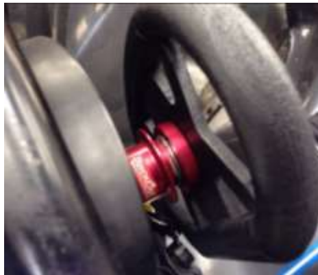
Figura 3. 25 Prototipo con el acople de conexión/desconexión rápida
