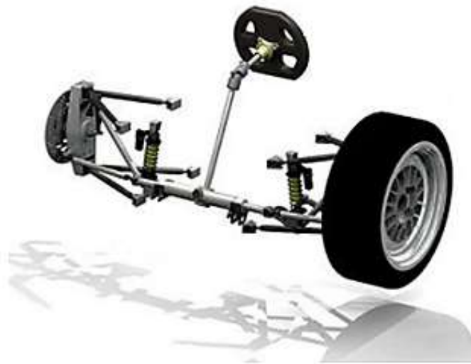
Figura 1. 2 Configuración y partes de sistema de dirección de un FSAE [4]
