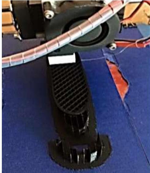
Figura 3. 19 Construcción del prototipo con 25% de densidad de material
