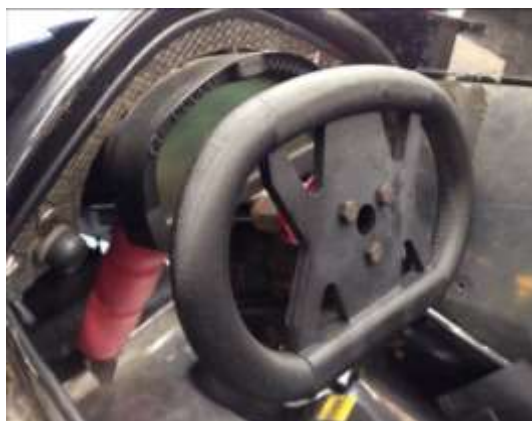
Figura 3. 26 Prototipo impreso mediante FDM montado en el monoplaza de UPS Racing Team
