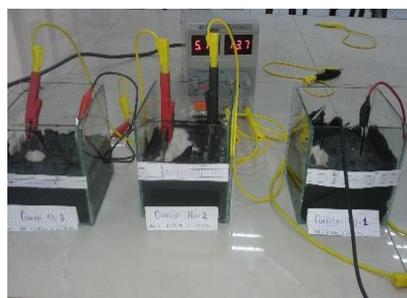
*Ilustración 14. Generación de hipoclorito de sodio.*
