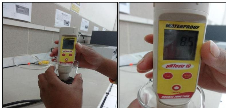
**Medición del pH con el pHTestr 10 de marca waterproof**
