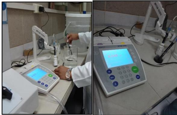
**Medición del pH con el pHmetro marca Mettler Toledo.**
