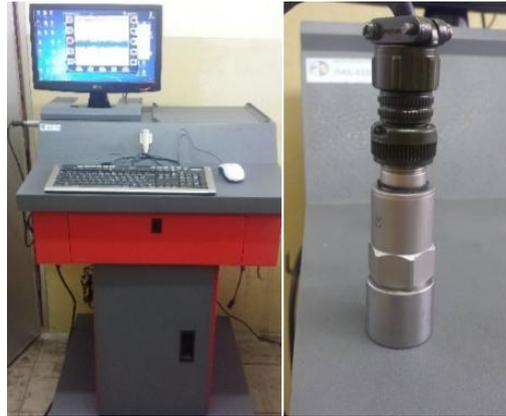
**Figura 4.** ADASH® y Acelerómetro.
