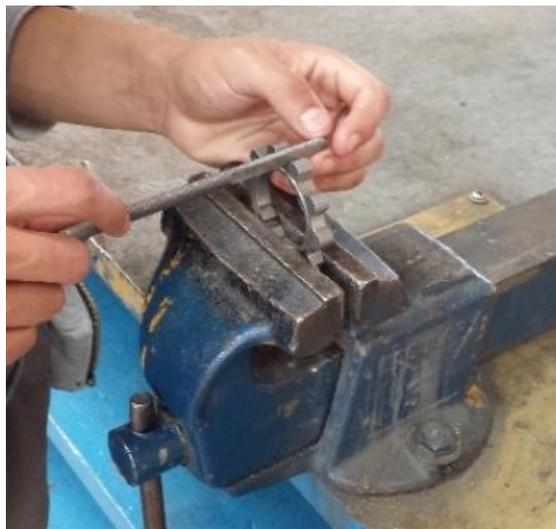
**Figura 2.** Desgaste del rotor interno de la bomba de aceite.
