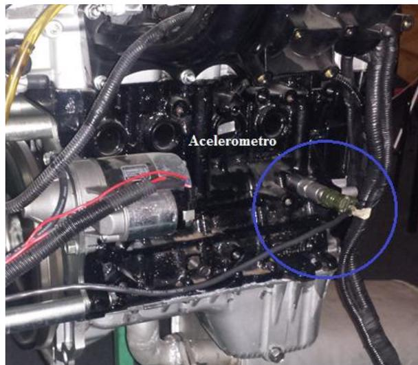
**Figura 6.** Ubicación del acelerómetro en el motor.
