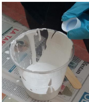
Figura 5. 11: Mezcla entre 100 gramos de Gel Coat y 3,51 gramos de Catalizador (MEK).
