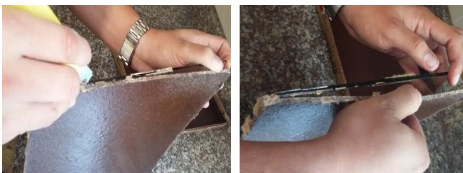
Figura 5. 47: Separación de la Placa de Vidrio y la Lámina de Composite de Fibra Natural en el Proceso de Desmolde.
