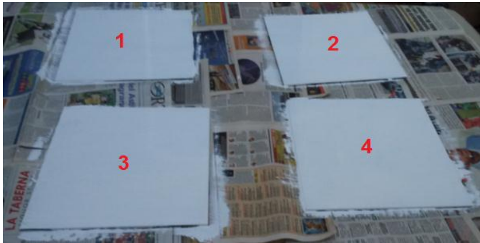
Figura 5. 13: Gel Coat Aplicado Sobre Todos los Cuatro Moldes.
