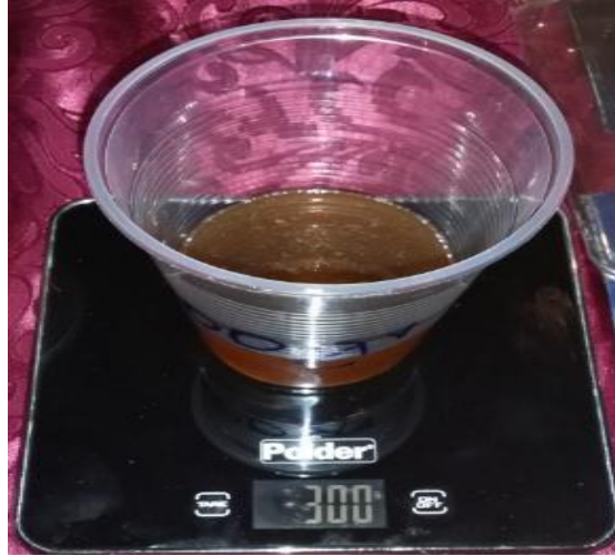
Figura 5. 43: Porcentaje de Resina Poliéster que se Utiliza Para Cada Uno de los Moldes.
