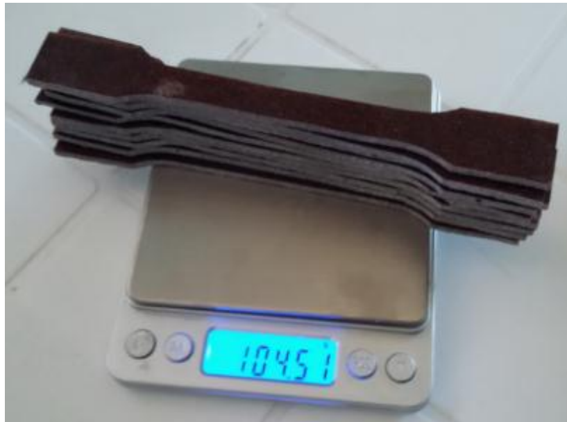
Figura 5. 52: Peso en Gramos de 10 Probetas de Composite de 20% de Fibra Natural de Caña Guadua.
