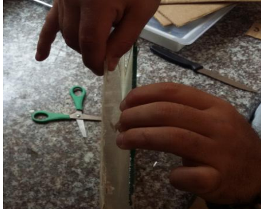
Figura 5. 21: Separación del Vidrio y la Lámina de Composite de Fibra de Vidrio en el Proceso de Desmolde.
