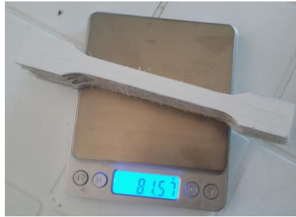
Figura 5. 27: Peso en Gramos de 10 Probetas de Composite de Fibra de Vidrio de 3 Capas.
