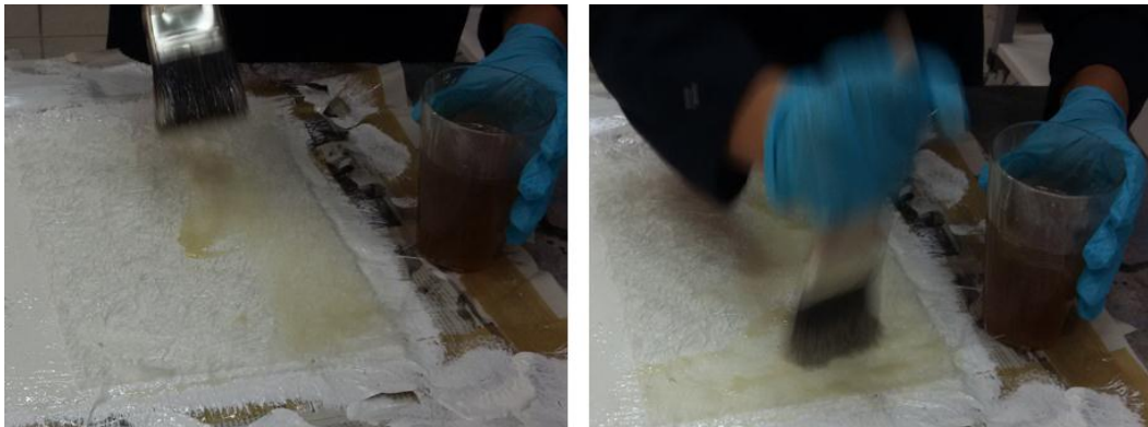
Figura 5. 18: Colocación de la Segunda y Tercera Capa de Resina Poliéster y Fibra de Vidrio.
