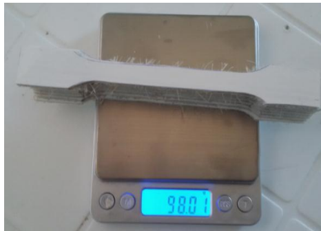
Figura 5. 28: Peso en Gramos de 10 Probetas de Composite de Fibra de Vidrio de 4 Capas.
