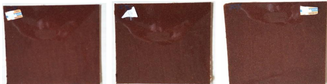
Figura 5. 48: De Izquierda a Derecha: Láminas de Composite de 10%, 15% y 20% de Fibra Natural de Caña Guadua Respectivamente.
