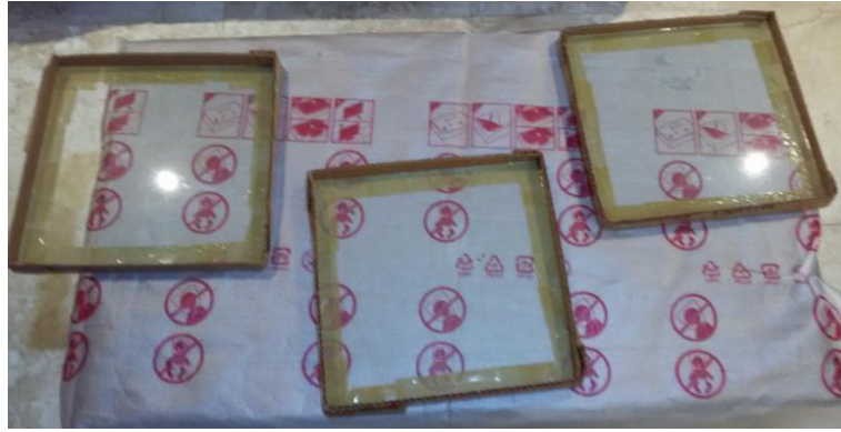
Figura 5. 41: Obtención de los Moldes Cerrados Para el Vaciado del Composite de Fibra Natural.
