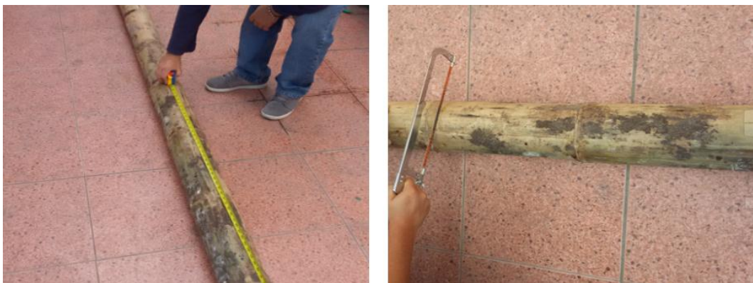
Figura 5. 30: Medición y Corte del Tallo de la Caña Guadua.
