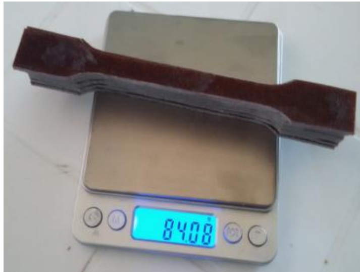
Figura 5. 50: Peso en Gramos de 10 Probetas de Composite de 10% de Fibra Natural de Caña Guadua.
