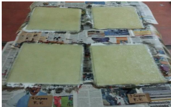
Figura 5. 20: Láminas Terminadas de Composite de Fibra de Vidrio para su Posterior Secado.
