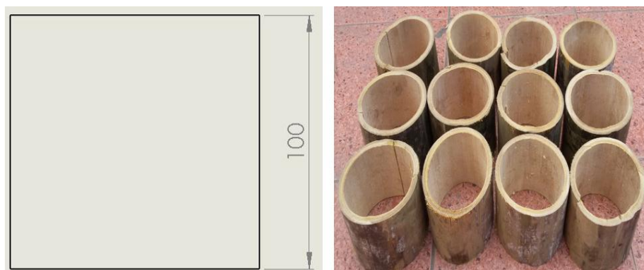
Figura 5. 32: Corte de 100 mm de los 6 entrenudos del tallo de la caña guadua.
