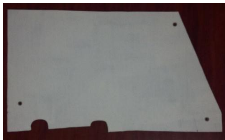
Figura 6. 18: Tapa Lateral Construida de Composite Reforzado con 3 Capas Fibras de Vidrio.
