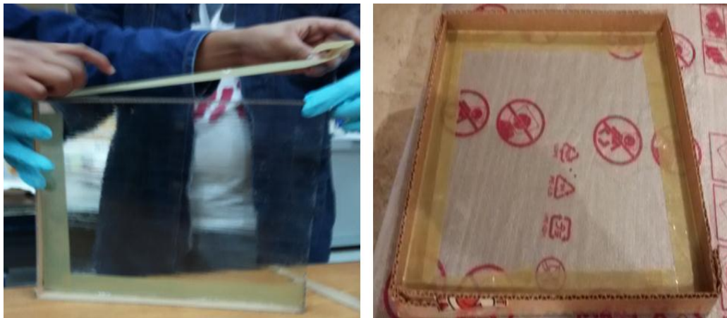
Figura 5. 40: Fabricación de los Moldes Cerrados Para el Vaciado del Composite de Fibra Natural.
