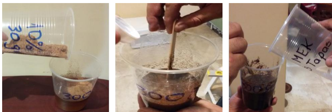
Figura 5. 44: Preparación de la Mezcla (Resina Poliéster + Fibra Natural + Catalizador).
