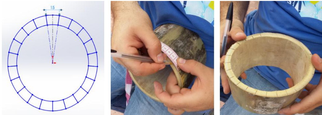
Figura 5. 33: Toma de Medidas y Trazado Alrededor de los 12 Entrenudos de 100 mm. de Caña Guadua.
