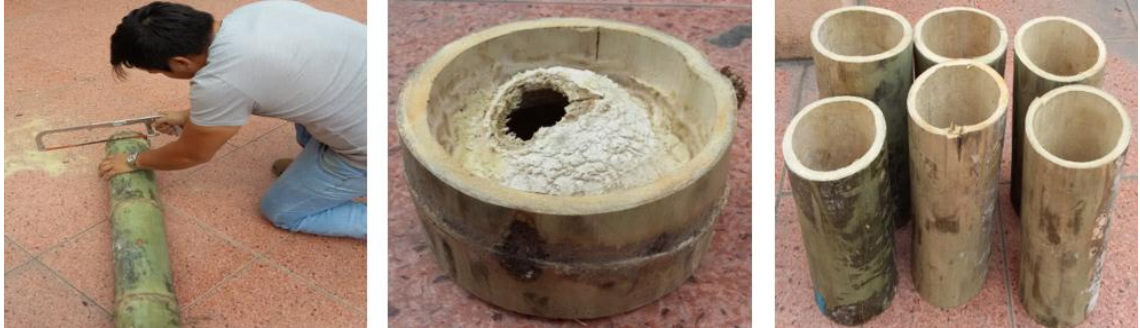
Figura 5. 31: Corte de los Nudos Macizos y Obtención de los Entrenudos del Tallo de la Caña Guadua.
