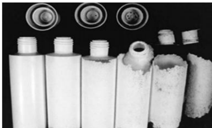
Figura 4. 29: Degradación de un Envase de P(3HB-CO-3HV) en Lodo Activado Durante un Periodo de 0, 2, 4, 6 ,8 y 10 Semanas.
