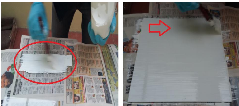
Figura 5. 12: Aplicación de Gel Coat sobre la Superficie del Vidrio Cubierto por el Alcohol Polivinílico.
