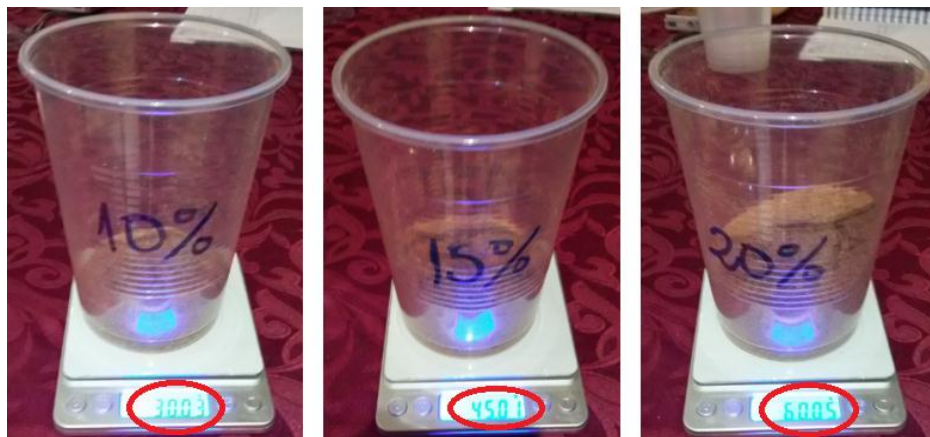
Figura 5. 42: Porcentaje de Fibra Natural de Caña Guadua a Utilizarse en los 3 Moldes.
