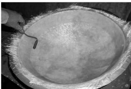
Figura 4. 28: Fabricación de un Domo por Estratificación Manual.
