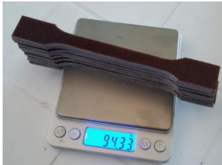
Figura 5. 51: Peso en Gramos de 10 Probetas de Composite de 15% de Fibra Natural de Caña Guadua.
