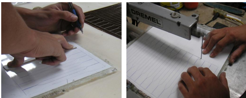
Figura 5. 24: Trazado en la Superficie de las Láminas de Composite de Fibra de Vidrio y Corte de las Probetas.
