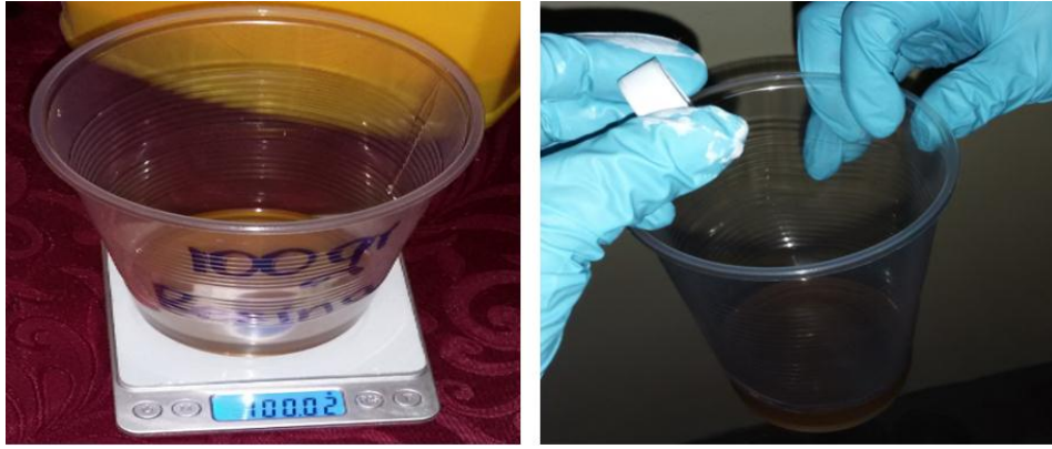
Figura 5. 16: Mezcla entre 100 gramos de Resina Poliéster y 3,51 gramos de Catalizador (MEK).
