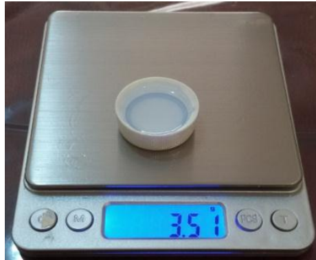
Figura 5. 9: Gramos de MEK Requerido por Cada 100 gramos de Gel Coat y Resina Poliéster.
