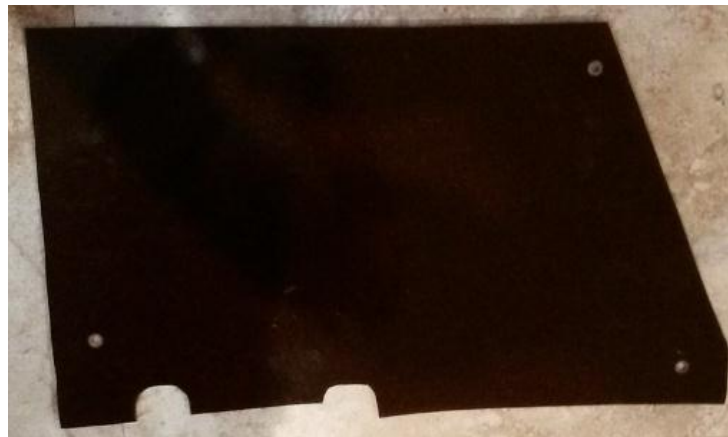
Figura 6. 19 : Tapa Lateral Construida de Composite Reforzado con 15% de Fibra de Caña Guadua.
