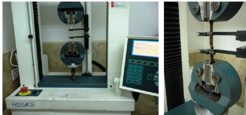
Figura 6. 1: Ensayo de Tracción Realizado en una Probeta de Material Compuesto Siguiendo los Parámetros de la Norma ASTM D638-14.
