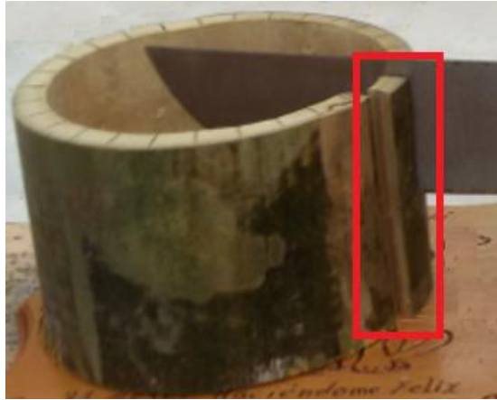
Figura 5. 34: Corte de las Latillas de Aproximadamente 15 mm. de Ancho por 100 mm. de Largo.
