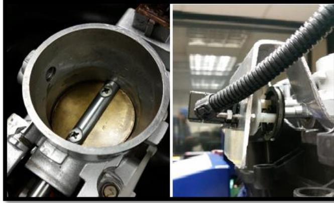
Fig. 52: servo motor del cuerpo de aceleración
