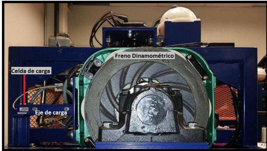
*Fig. 54 Freno dinamométrico y su respectivo eje de acoplamiento
