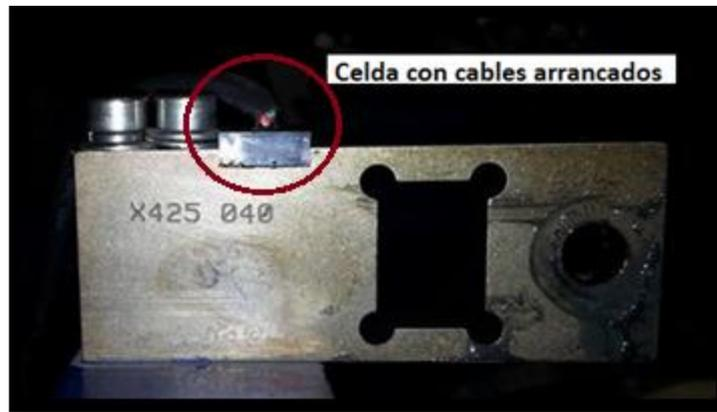
Fig. 11: Celda de carga original en mal estado
