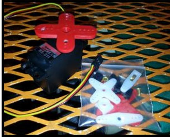
Ilustración 43: Servo motor para control de la mariposa de aceleración
