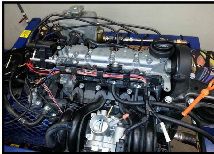
*Fig. 60: conexión de sensores y actuadores del motor
