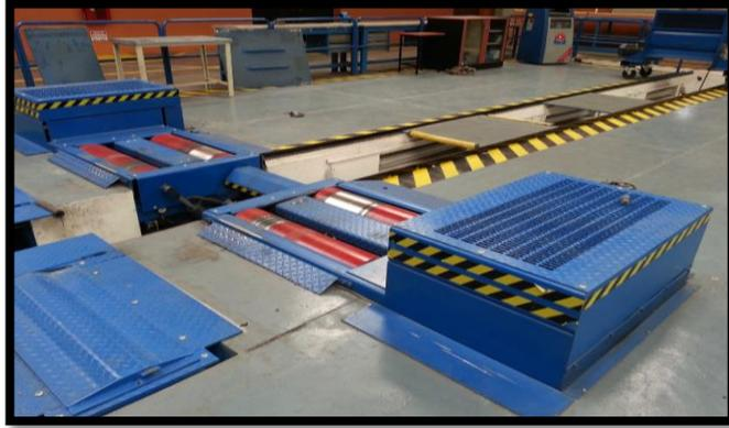
*Fig. 1: Banco dinamométrico de chasis*
