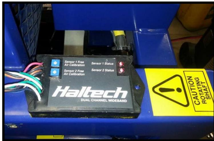
Fig. 62: Calibrador de Lambda
