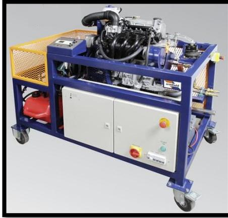
Fig. 2: Banco dinamométrico acoplado al eje
