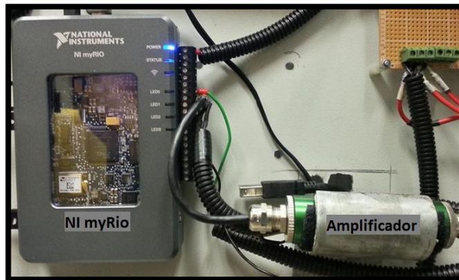
*Fig. 16: NI myRio y amplificador de la celda de carga*
