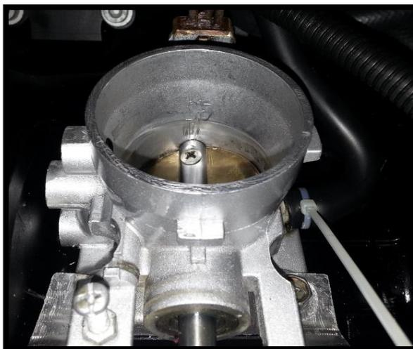
*Ilustración 42: Cuerpo de aceleración para adaptar*
