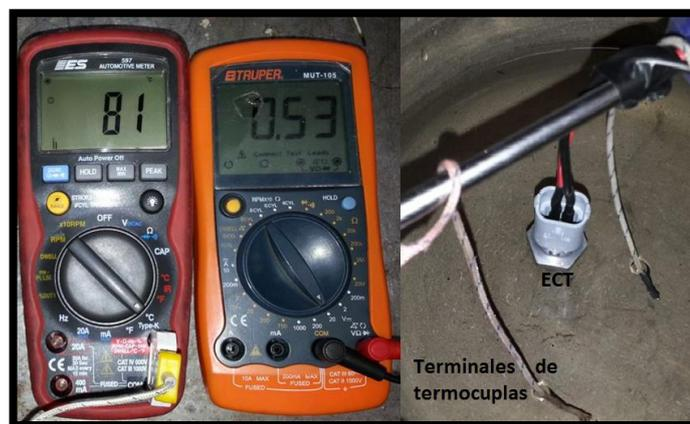
Fig. 22: Variación de voltaje y resistencia del ECT en relación a la temperatura
