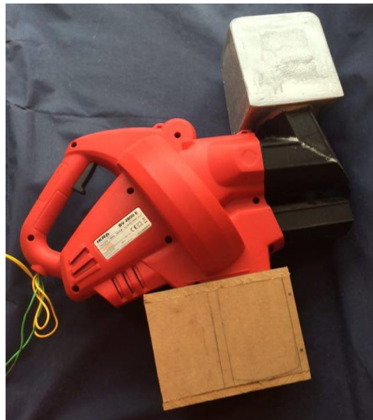
Figura 42: Ensamble completo de la aspiradora con la caja de aspiración y expulsión.
