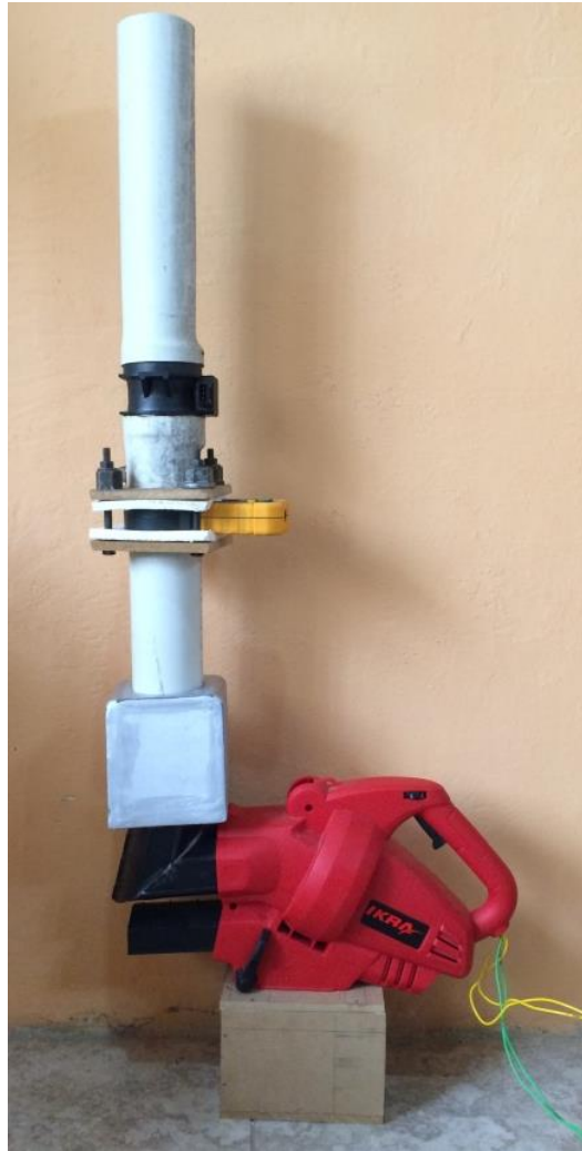
Figura 47: Sistema de muestreo para adquisición de datos.
