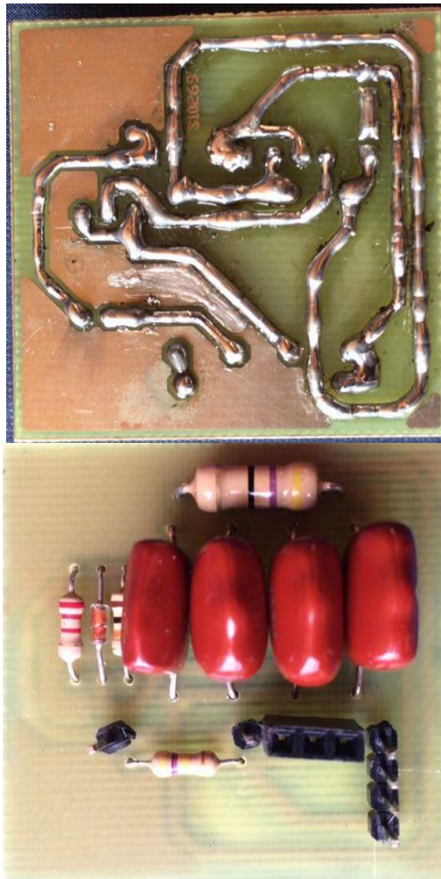
Figura 46: Capa de estaño sobre las pistas de la placa y vista frontal de la placa terminada. Fuente: El Autor.
