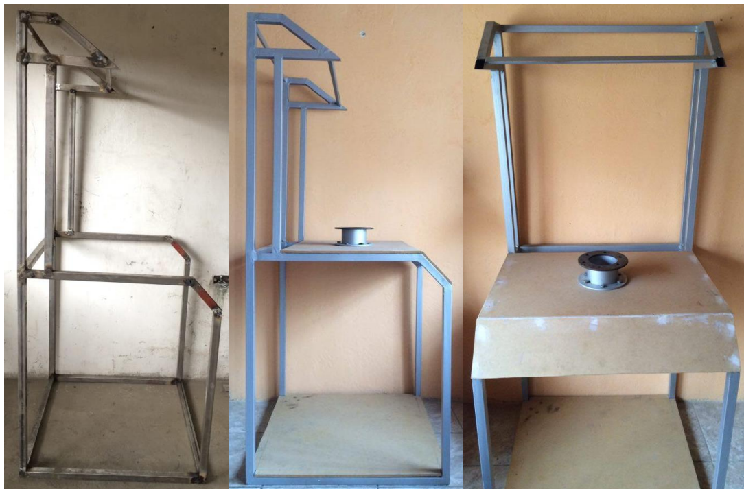
Figura 34: Proceso de construcción del bastidor.
