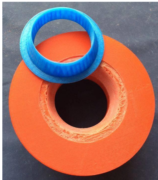
Figura 37: Acople general con el acople para culata de cilindros de hasta 85 mm de diámetro. Fuente: El Autor.
