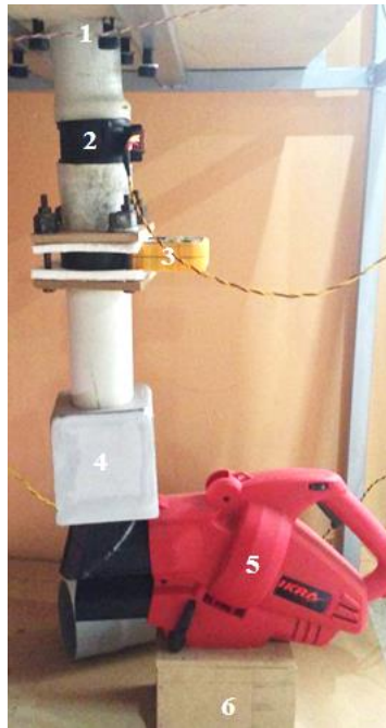
Figura 67: Partes del sistema de muestreo.
