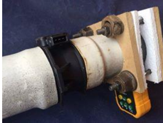
Figura 64: Colocación del sensor en el sistema de muestreo.
