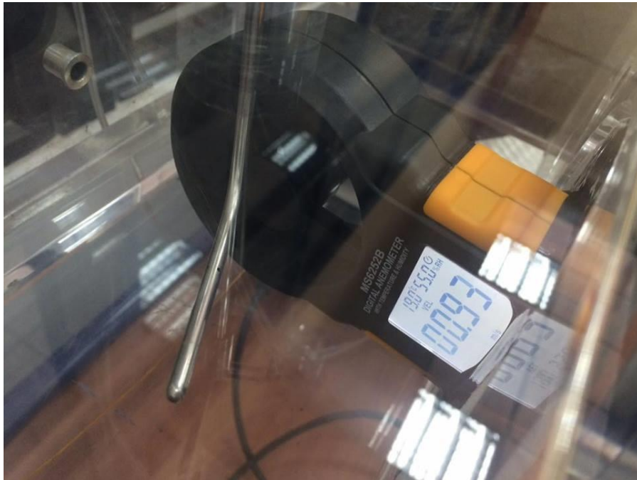
Figura 55: Colocación del anemómetro y el tubo de medición dentro del túnel de viento.
