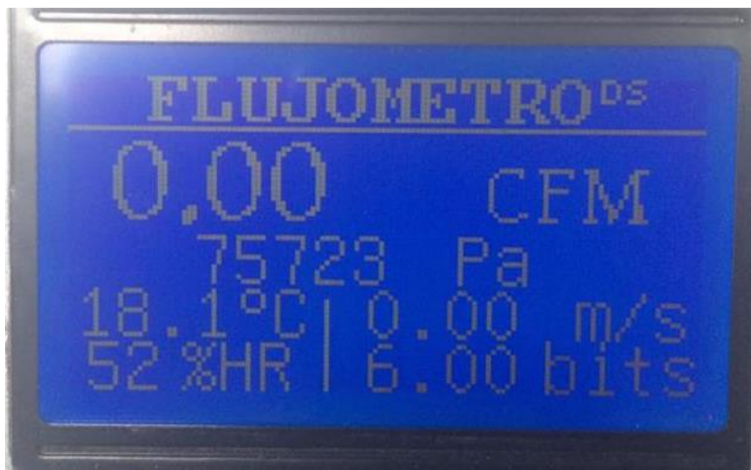
Figura 91: Comprobación de funcionamiento del display y lectura de datos. Fuente: El Autor.
