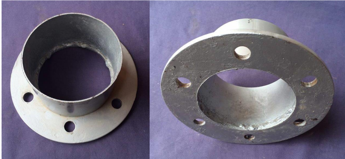
Figura 35: Construcción del soporte de componentes con el disco de anclaje al bastidor. Fuente: El Autor.
