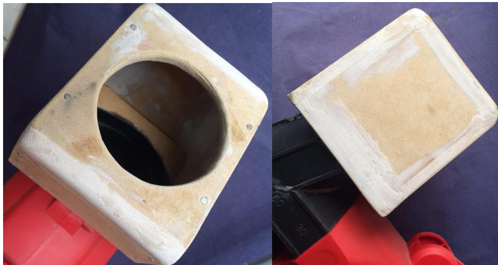
Figura 39: Boquilla de aspiración, vista lateral de la caja de aspiración.
