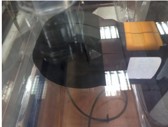
Figura 57: Colocación del anemómetro dentro de la cámara de ensayo. Fuente: El Autor.
