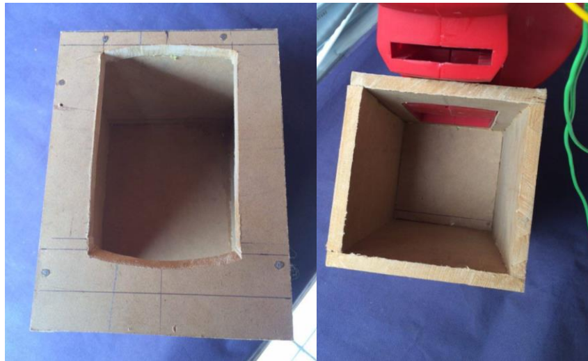
Figura 41: Caja de expulsión con acople a la aspiradora.
