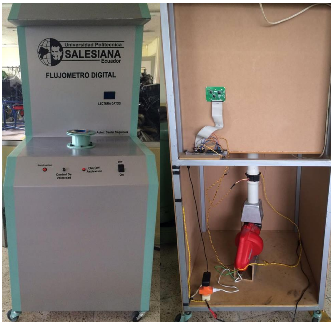
Figura: Vista frontal y posterior del flujometro terminado. Fuente: El Autor.
