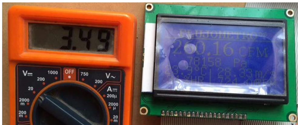
Figura 95: Pruebas de funcionamiento del sensor MAF, en función del voltaje.
