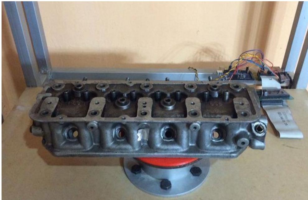
Figura 98: Montaje de la culata en el flujometro. Fuente: El Autor.
