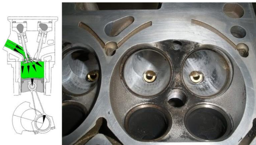
Figura 4: Mecanizado de Conductos de Admisión.
