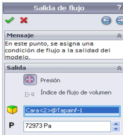
Figura 24. Proceso de simulación en SolidWorks, valores de presión de salida.
