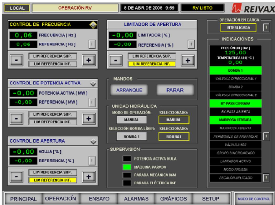
Figura 30. Ejemplo de Pantalla de Operación e instrumentación (Central Los Chillos REIVAX)
