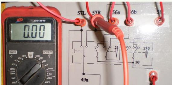
Si no existe voltaje de alimentación revisar la conexión de la palanca.
