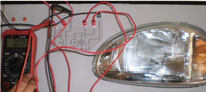
Si no existe voltaje en los pilotos; revisar la conexión entre la palanca y cada uno de los pilotos; Si existe voltaje posible falla: Pilotos quemados o portapilotos defectuosos
