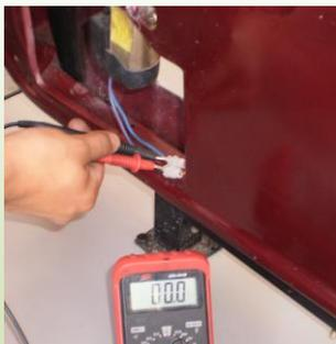
Si hay tensión y no sube ni baja la luna; posible falla: Motor defectuoso o sistema mecánico
