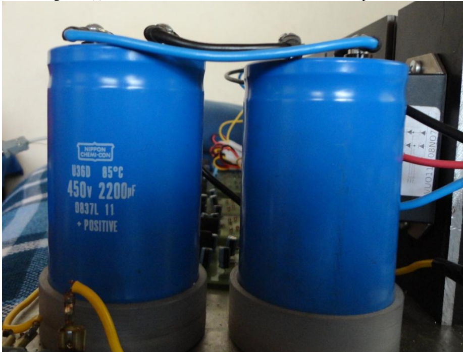
Fig. 1.22(b) Filtro capacitivo, paralelo de condensadores implementado.
