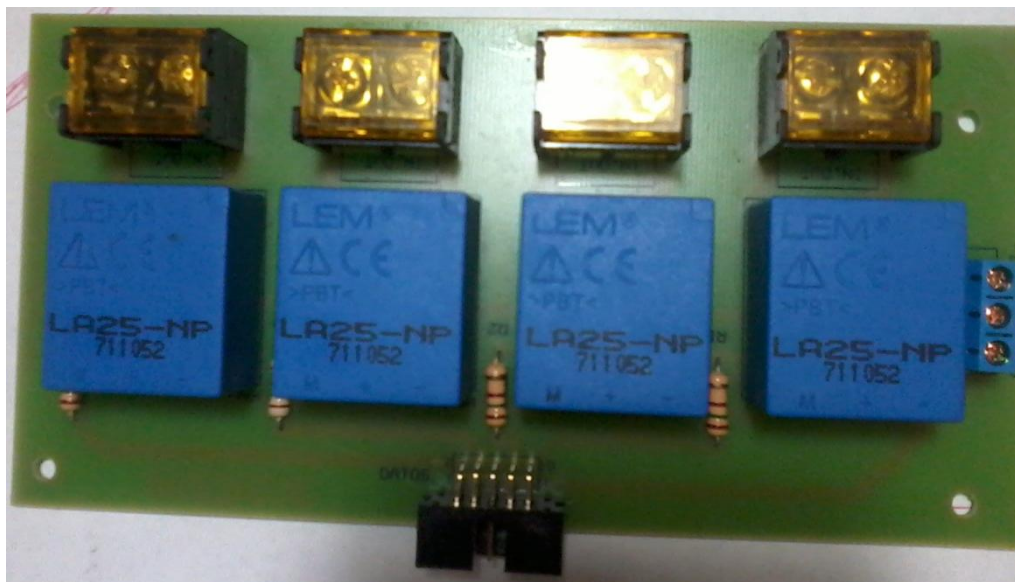
Fig.1.40PCB implementado con cuatro transductores LA25-NP.
