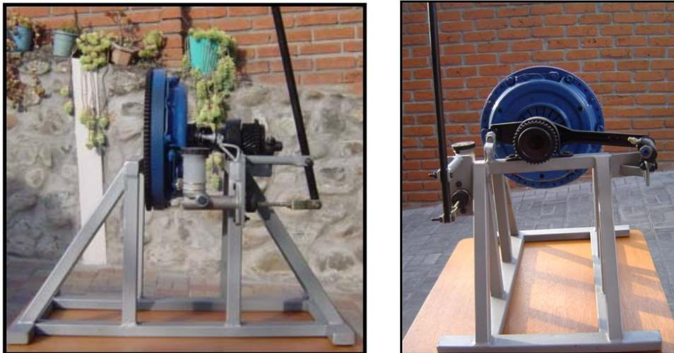
**Fig.2.5.1.- Maqueta reconstruida con accionamiento hidráulico.**
