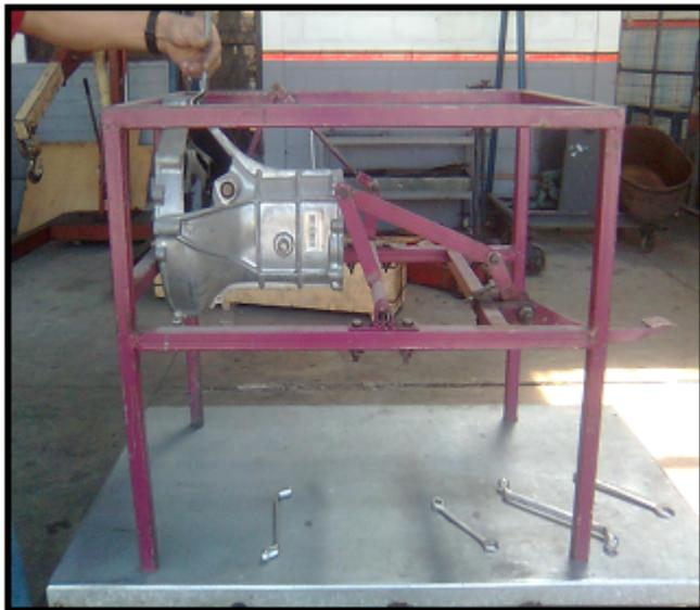
*Fig.2.2.3 y Fig.2.2.4 Maquetas con mando por varilla.*
