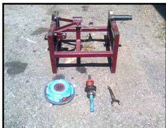
**Fig.2.2.6 y Fig.2.2.7.- Despiece de la maqueta con mando por cable.**
