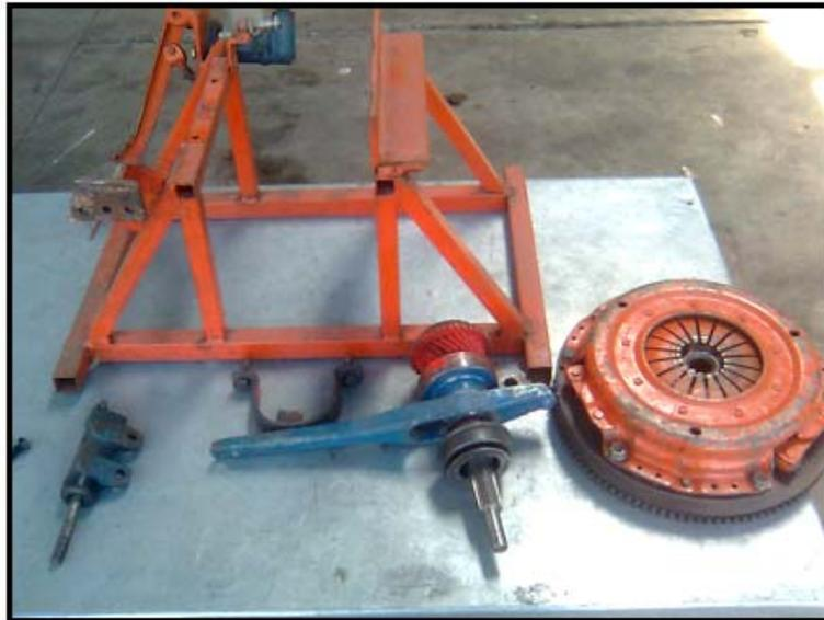
*Fig.2.2.11.- despiece de la maqueta con mando hidráulico.*
