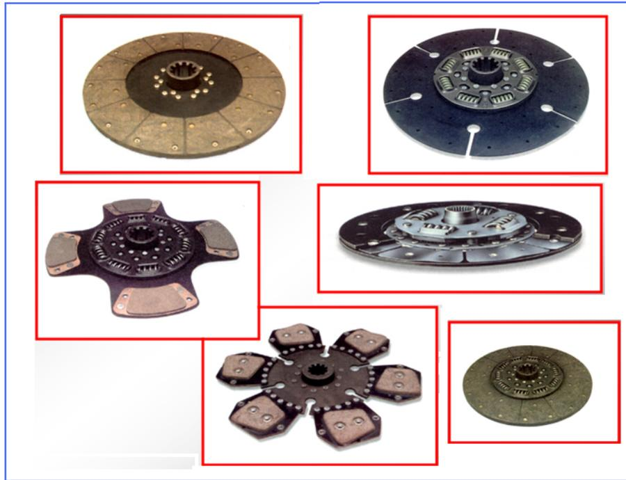
*Figura .-1.1.2. Diseños de discos de fricción.*
