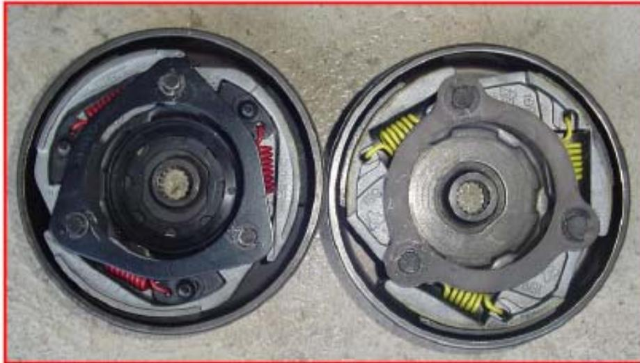
*Fig.9.1.1.- Embragues centrífugos de segmentos basculantes.*
