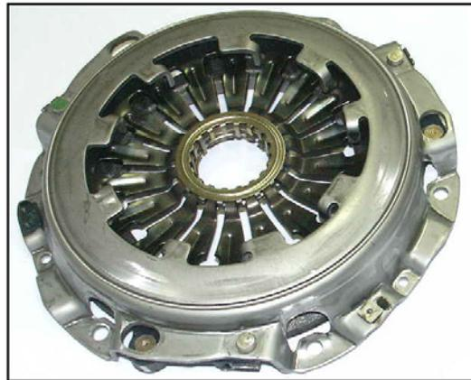
*Figura.- 1.3. Carcasa con muelle de diafragma visible.*
