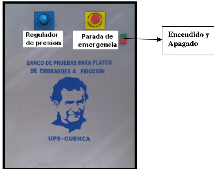
***Fig.-4.3.2.Valvula reguladora de presión, botón de encendido y botón de parada de emergencia.***
