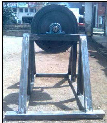
*Fig. 2.4.2.- Estructura para el embrague hidroneumático.*
