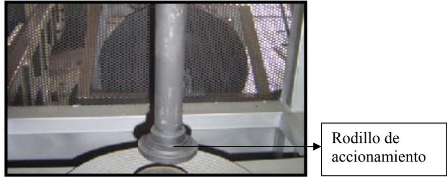
*Fig.-3.4.3.4. Rodillo de accionamiento.*
