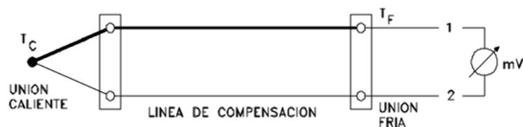
Figura 2 .Diagramación de la estructura interna de las termocuplas
