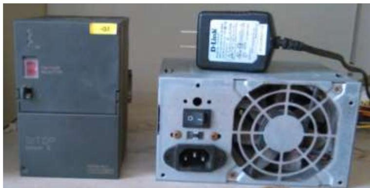
Figura 16. Fuentes de alimentación para polarización de sensores y alimentación de circuitos de control en el banco de instrumentación.
