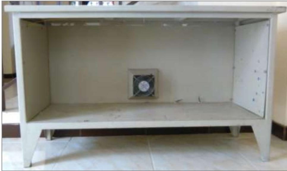
Figura 13. Banco de alojamiento para contraste de las variables físicas temperatura y presión.
