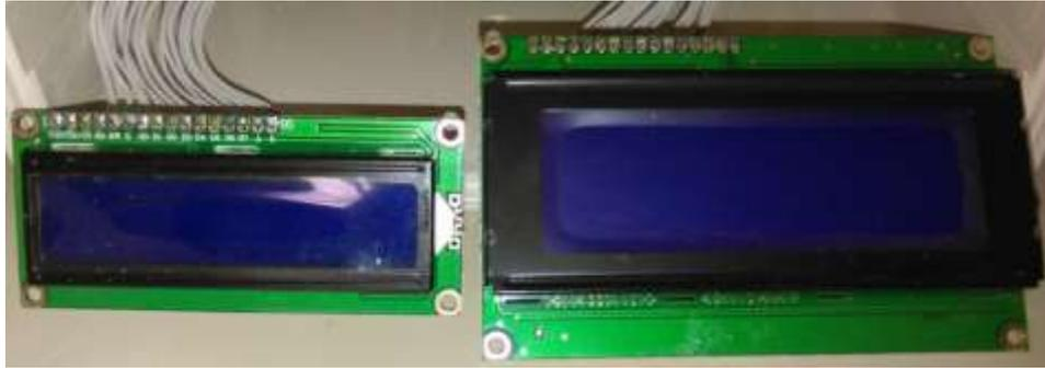
Figura 24. Foto real de los LCD 2x16 y 4x20.
