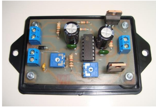
Fig. 4- 3 Ubicación de los trimmer en la placa
