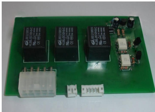
Fig. 3- 24 Circuito final de limpiaparabrisas automático
