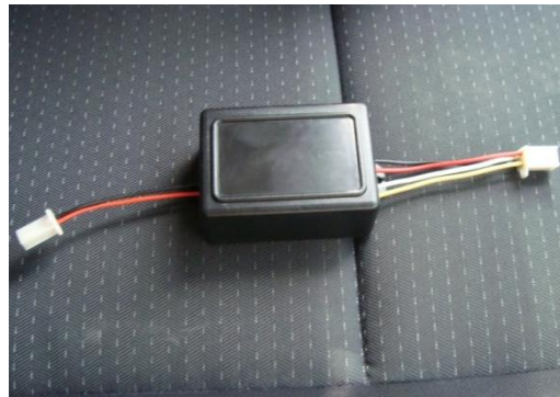
Fig. 3- 9 Módulo de encendido automático de luces de posición y de cruce
