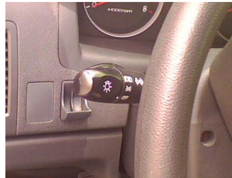
Fig. 1- 4 Conmutador de Luces
