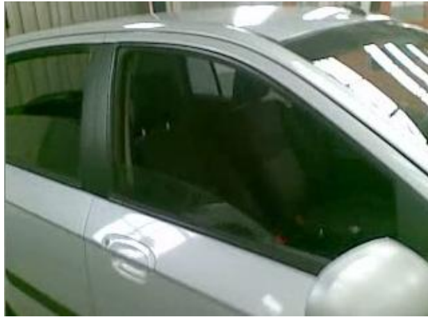
Fig. 4- 24 Vidrios abiertos antes de activar el cierre centralizado
