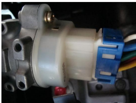
Fig. 1- 19 Parte posterior del switch
