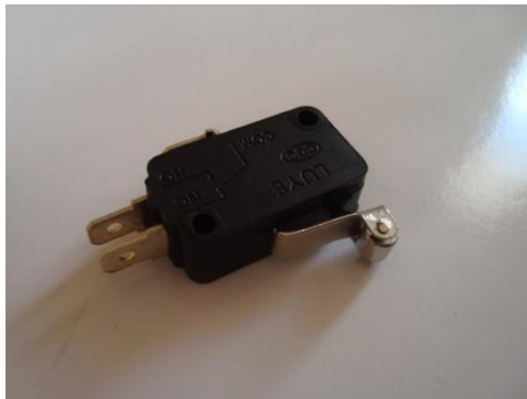
Fig. 4- 19 Final de carrera para cierre de puerta
