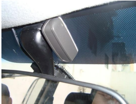
Fig. 4- 10 Ubicación del sensor en el interior
