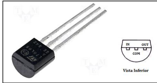
Fig. 2- 21 Forma Física y Esquema de Conexión 78L05
