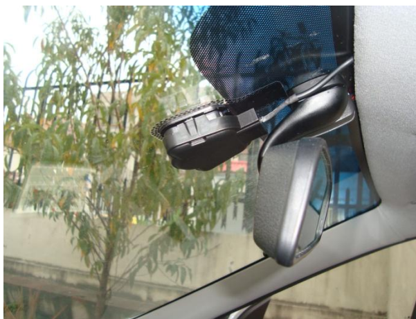
Fig. 3- 27 Ubicación del sensor por debajo del retrovisor
