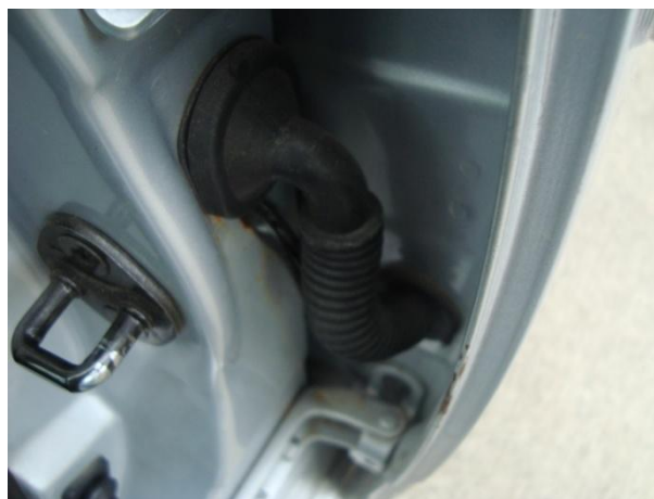
Fig. 3- 41 Cables para puertas traseras atravesados a través la carrocería
