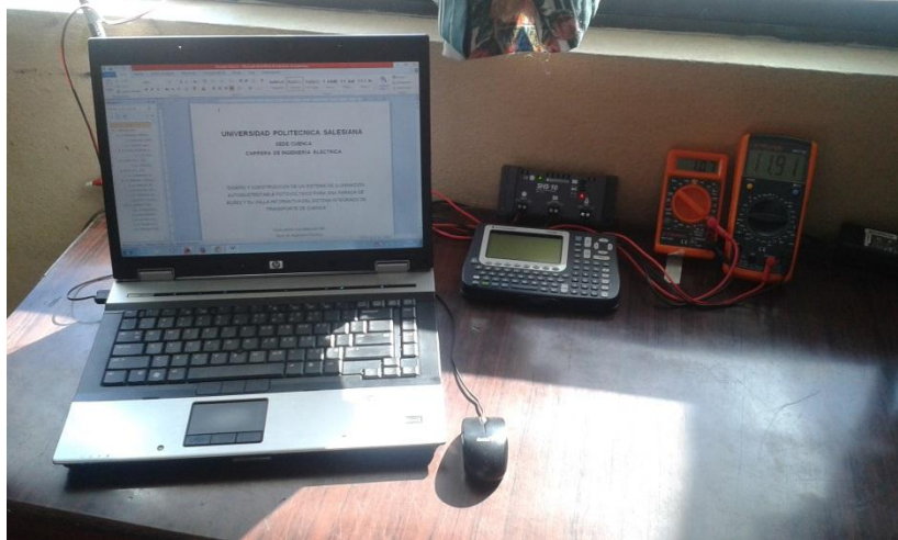
Figura 74. Medición de voltaje y corriente generado por el panel solar.
