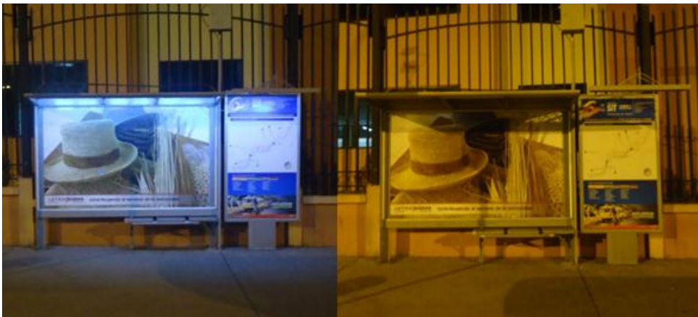
Figura 41. Contraste de iluminación LED de luz blanca con alumbrado público.
