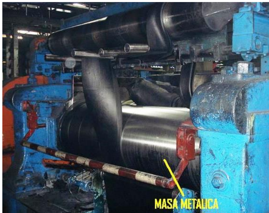
Figura # 21. Proceso de laminado del caucho.
