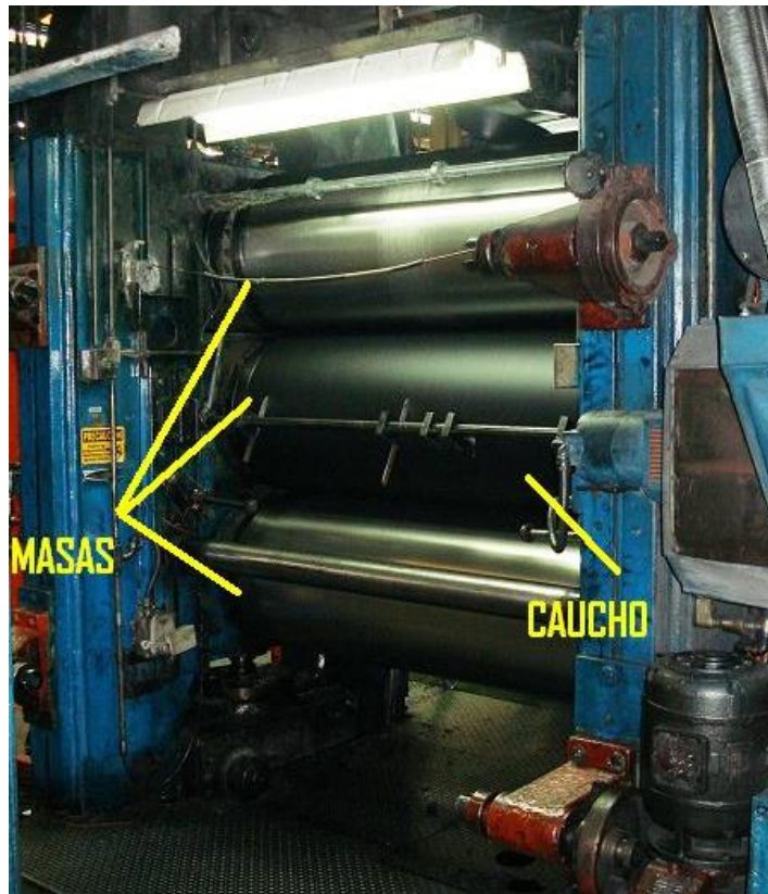
Fig. # 27 Proceso de aplicación de caucho en calandria.
