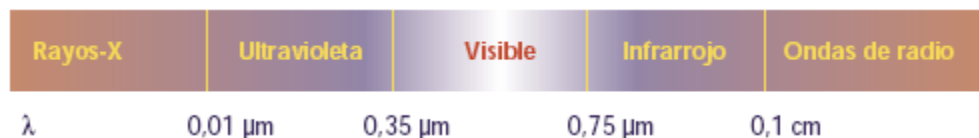
Fig. # 4 Representación esquemática del espectro electromagnético según su longitud de onda.
