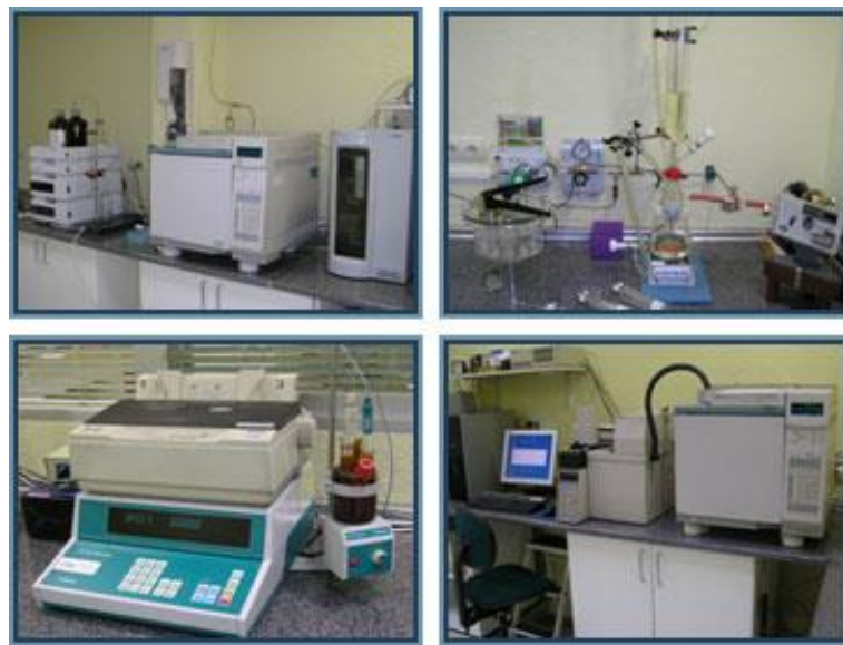
Fig. # 16 Equipos utilizados para la evaluación de aceites dieléctricos.
