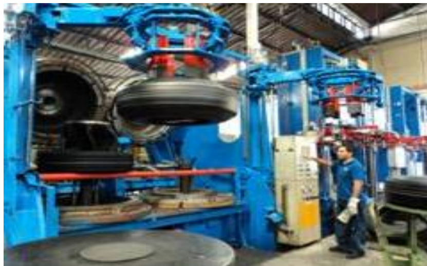
Fig. # 35 Proceso de vulcanizado de llantas.
