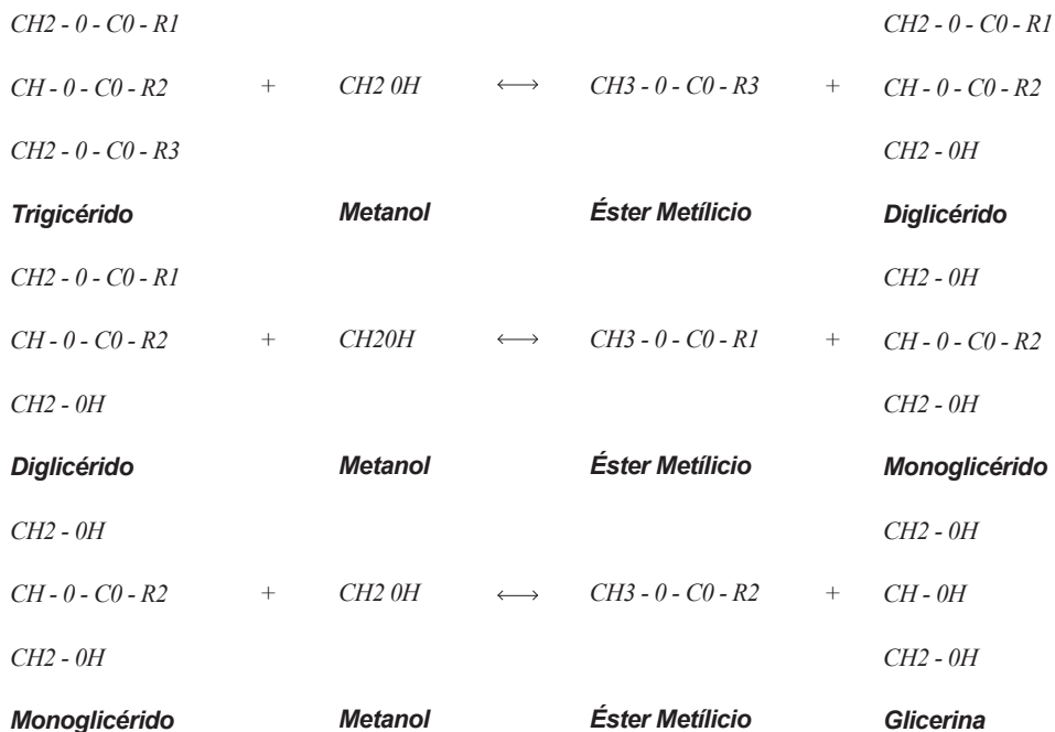
Figura 2 Reacciones que se producen en la transesterificación química con alcohol
