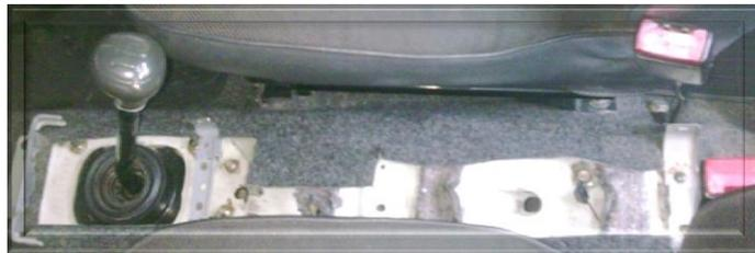
*Figura 3.29. Fotografía de la extracción de la palanca de freno de mano.*
