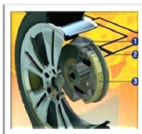
*Figura 1.13. Esquema básico de un sistema de freno de tambor.*
