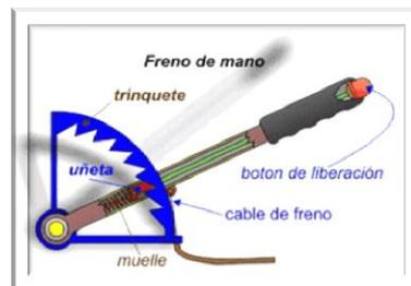
Figura 1.49. Palanca de accionamiento.
