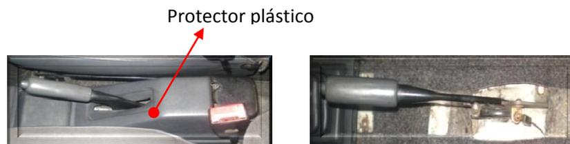
Figura 2.11. Fotografía de la extracción del protector plástico.
