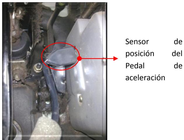
*Figura 3.54. Ubicación del sensor de posición del acelerador.*
