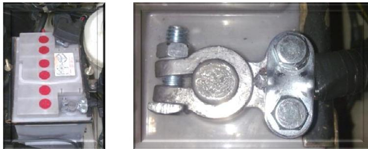
*Figura 3.65. Fotografía de los cables de alimentación a los bornes de la batería.*
