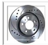
*Figura 1.38. Disco de freno perforado.*
