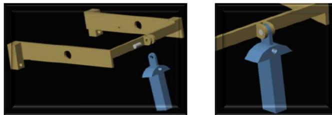
*Figura 3.18. Unión del enclavamiento y armadura móvil tipo T.*
