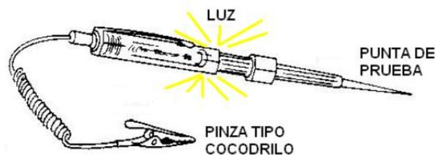
*Figura 4.1 Lámpara de prueba.*
