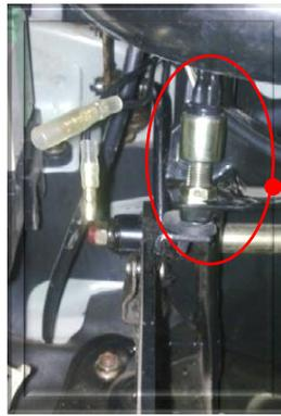
Sensor de posición del Pedal del embrague
