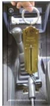
Figura 2.16. Medición de la fuerza en la palanca de freno de mano.
