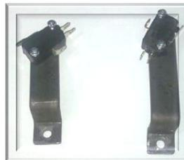
*Figura 3.50. Fotografía de la fijación de los sensores a las placas de soporte.*
