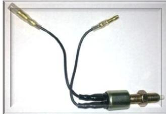
*Figura 3.55. Sensor de posición del pedal del embrague.*
