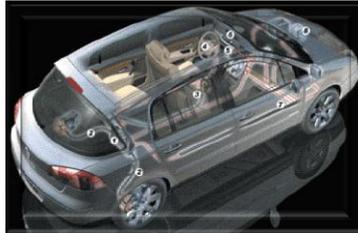
*Figura 1.52. Elementos de un sistema de freno automático (Renault).*
