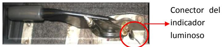
*Figura 3.26. Fotografía del conector del indicador luminoso.*
