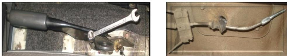
*Figura 3.27. Fotografía de la extracción del cable de accionamiento del freno de mano.*
