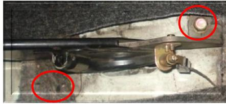
*Figura 3.28. Fotografía de la extracción de los pernos de sujeción de la palanca de freno de mano.*
