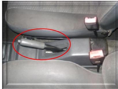
*Figura 2.5. Fotografía de la palanca de freno de mano.*
