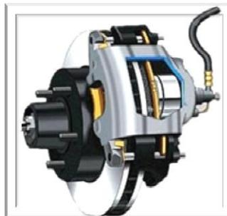
*Figura 1.31. Sistema de freno de disco.*
