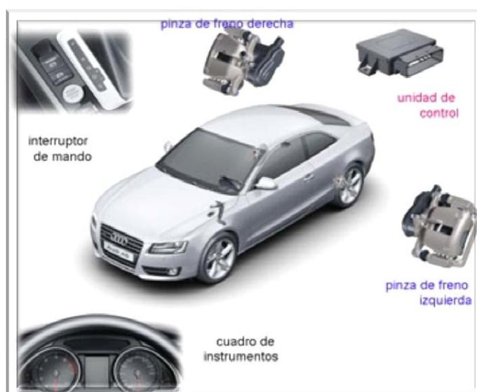
*Figura 1.56. Componentes básicos del sistema EPB2.*
