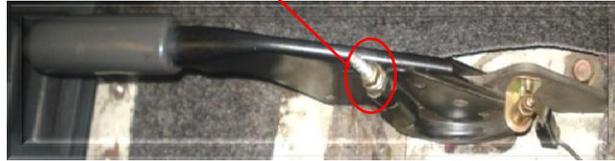
*Figura 2.7. Fotografía de la ubicación del cable de accionamiento dentro del habitáculo.*
