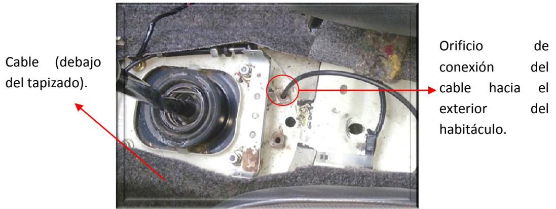
*Figura 3.42. Fotografía de la ubicación del cable de control.*
