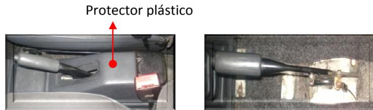
*Figura 3.25. Fotografía de la extracción del protector plástico.*
