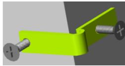
*Figura 2.53. Placa de sujeción del forro del cable de control.*
