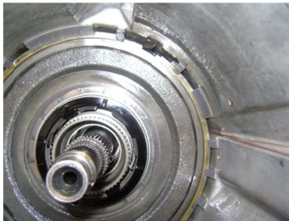
Extracción de carcasa de tren epicycloide
