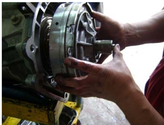
Extracción de la bomba de aceite.
