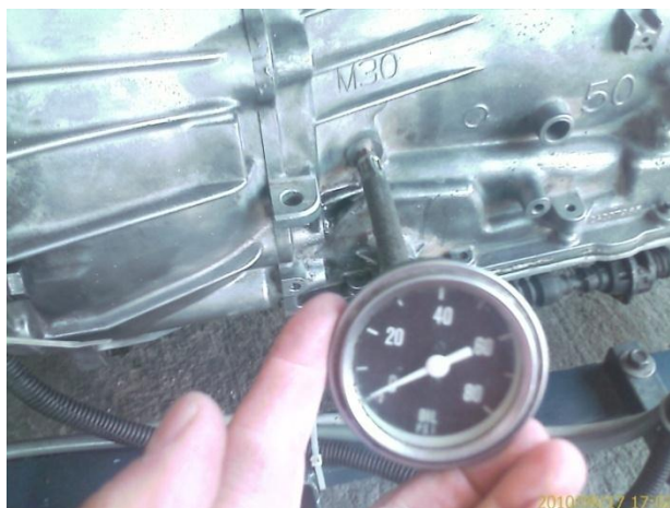
Figura 4.24 Colocación del manómetro a la toma de presión de la caja.
