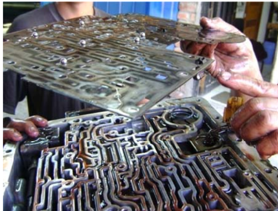
Separación de placa del cerebro hidráulico
