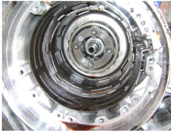
Extracción de banda de fricción
