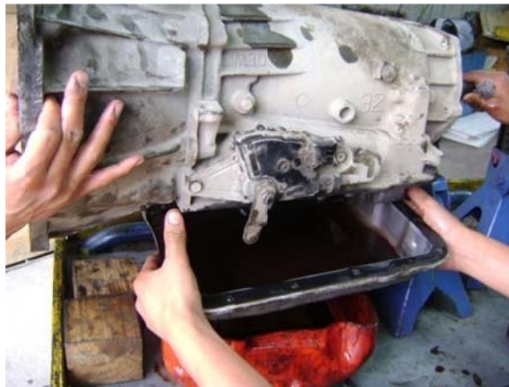
Extracción del cárter de aceite de la transmisión.
