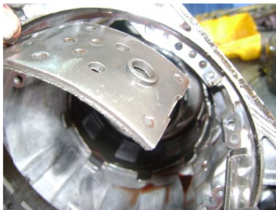
Extracción de banda de fricción.
