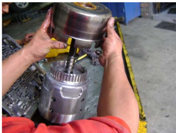
Desensamblaje del tren epicycloide.
