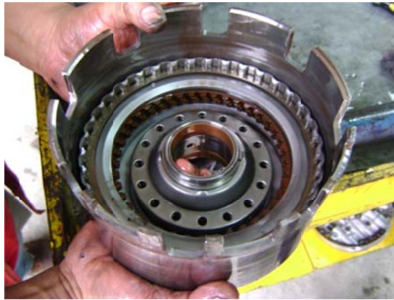
Desensamblaje de los discos de fricción del tren epicycloide.
