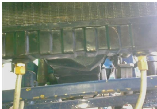
Figura 2.64 Adaptación del enfriador de aceite al radiador
