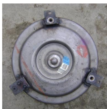
Figura 2.49 Platinas soldadas al convertidor
