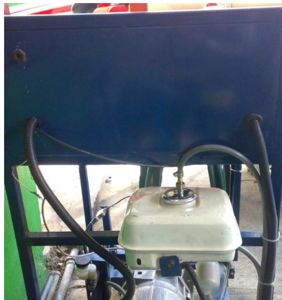
Figura 2.74 Adaptación del tanque de combustible
