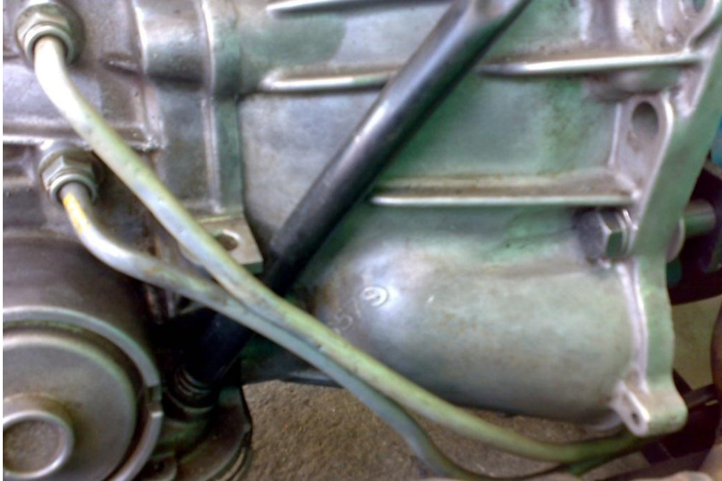
Figura 2.65 Cañerías de lubricación del aceite de la caja de cambios
