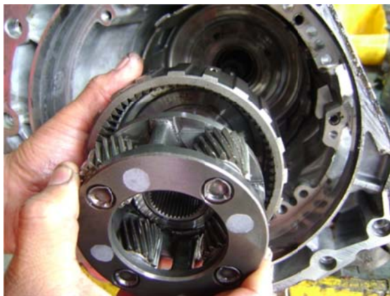
Extracción de porta satélites, satélites junto el tren epicloide
