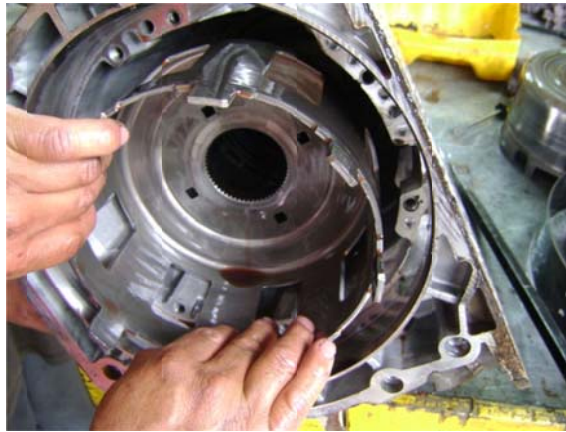
Extracción de carcasa de tren epicycloide
