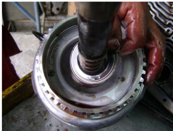
Desensamblaje del tren epicycloide.
