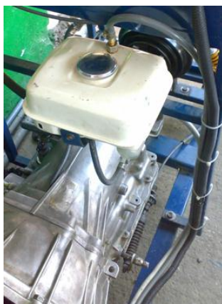
Figura 2.75 Cañerías del tanque de combustible.
