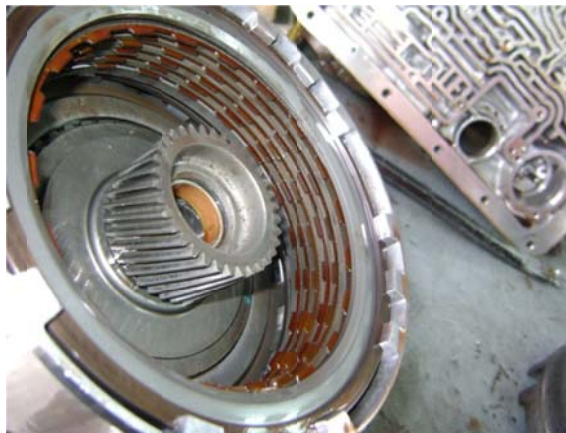
Desensamblaje de los discos y banda de fricción del tren epicycloide.
