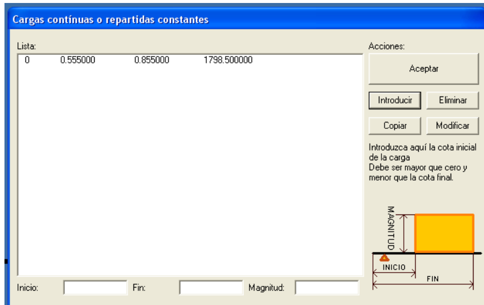
Figura 2.39 cargas distribuidas de la viga.
