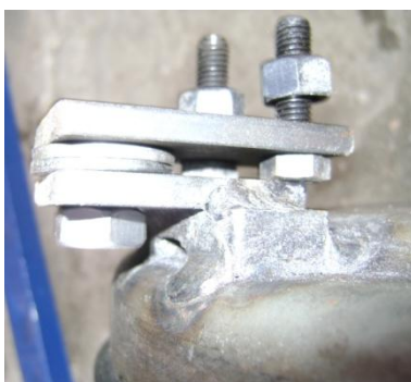
Figura 2.48 Adaptación de las platinas para unión volante-convertidor
