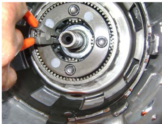
Extracción de tren epicloide.
