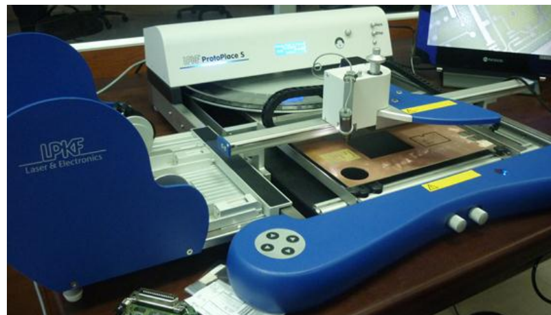
Figura 3.66. Equipo ProtoPlace S para posicionamiento de componentes SMD.
