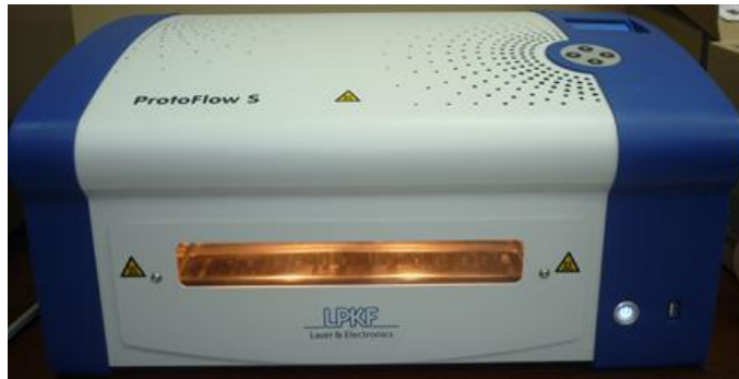
Figura 3.69. Equipo ProtoFlow S para soldadura de componentes
