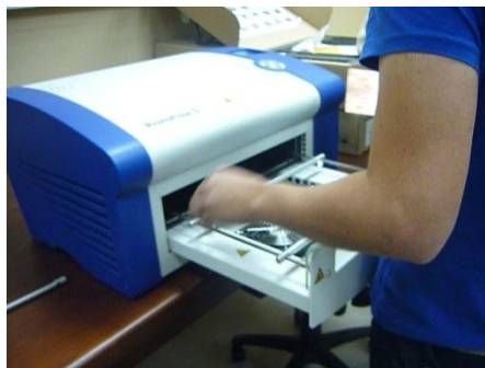
Figura 3.71. Etapa de soldado de componentes en la máquina ProtoFlow S
