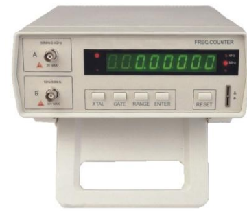
Figura 2.13. Frecuencímetro de banco DIT-2400.
