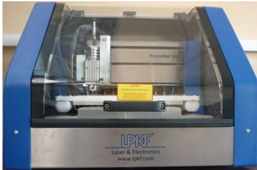
Figura 3.60. Equipo ProtoMat S62 para mecanizado.
