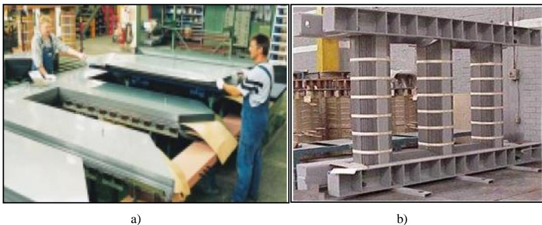
Figura 1.8 a) Ensamblaje "E", b) Núcleo terminado antes de la adición de bobinas.
